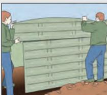
Betonplatten zur Unterstützung auf Fundament auflegen. Wichtig bei doppelseitiger Montage.
