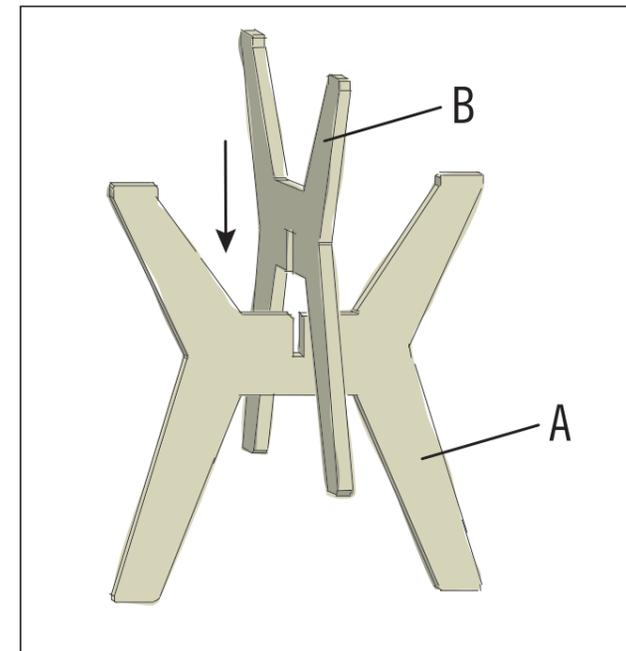
Stelle das Fussteil (A) so auf, dass die beiden angefrässten Enden und der Schlitz nach oben zeigen. Beim zweiten Fussteil (B) zeigt der Schlitz nach unten. Stecke beide Teile soweit zusammen, bis sie an den Schlitz vollständig zusammengefügt sind.
