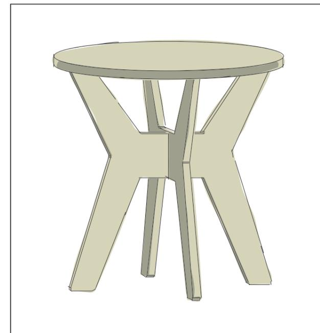
Richte die Tischplatte so aus, dass sich die Fussteile in die Aussparungen der Tischplatte einstecken lassen. Mit leichten Hammerschlägen (einen weissen Gummihammer verwenden!) die Platte mit den Fussteilen verbinden. Je nach Verwendung muss das Holz mit einem schützenden Anstrich versehen werden.
