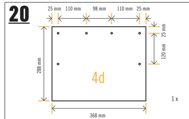
**Zuschnitt für Aufbewahrungsfach** Mit dem Plattenzuschnitt «4d» wird die Obstkiste «3» abgetrennt damit ein Aufbewahrungsfach entsteht. Nach dem Zuschnitt wird sie für die Verschraubung mit  $\varnothing 4$  mm vorgebohrt und gesenkt.
