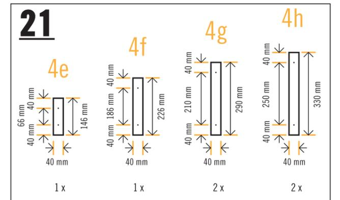
**Zuschnitte für Rahmen der Abdeckplatte** Für den Rahmen der Abdeckplatte «4i» werden die Zuschnitte «4e», «4f», «4g» und «4h» angefertigt, gebohrt und gesenkt.
