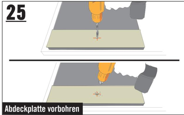
**25** **Abdeckplatte vorbohren**
