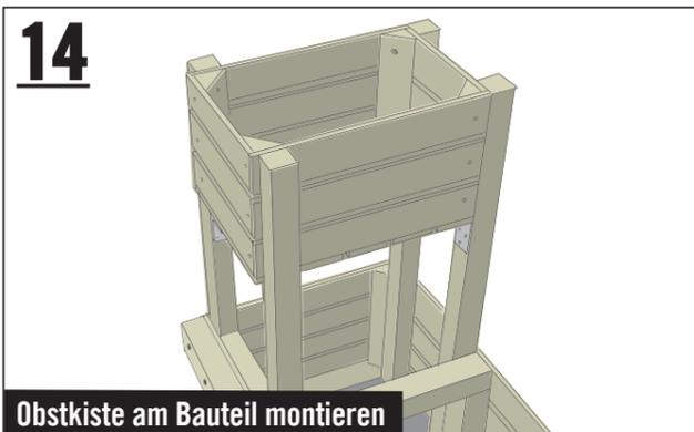
**14** Obstkiste am Bauteil montieren
