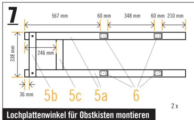
**Lochplattenwinkel für Obstkisten montieren**
