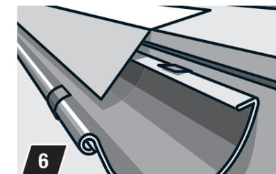
Der Rinneneinhang bietet zusätzlichen Schutz vor Regenwasser und Flugschnee. Er wird in die Abkantung der Dachrinne eingehängt und mit Pappstiften auf der Dachlatte festgenagelt. Die kurzen Rinnenhalter 80 mm (c) können direkt auf dem Traufbrett montiert werden (Abb. 6).
