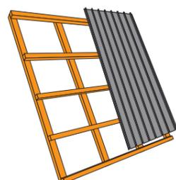
Wird das Trapezblech auf einen unebenen, nicht dichten Altbelag verlegt, so ist eine Holzlattung zum Abführen des Kondenswassers erforderlich. Die Latten müssen evtl. unterfüttert werden, sodass eine ebene Unterkonstruktion entsteht.
