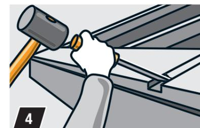
Schlitz ausstemmen (Abb. 4), damit die Eisen bündig in die Sparren eingelassen werden können. Vor der Befestigung müssen die langen Rinnenhalter abgebogen werden. Das Abbiegen geht am einfachsten mit einer großen Kneifzange oder im Schraubstock.
