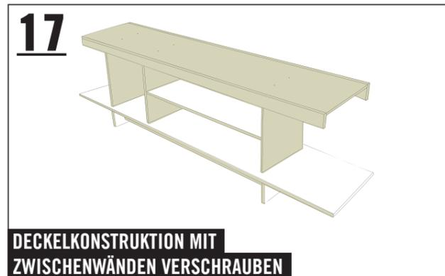
**17 DECKELKONSTRUKTION MIT ZWISCHENWÄNDEN VERSCHRAUBEN**
