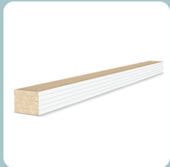
Aufdopplungsprofil für Um- fassungszargen: 5 x Abmessung 2100 x 140 x 22 mm. Optional zum Einbau von Umfassung- zargen, wenn keine Laibung vorhanden ist und die Zargen zwischen zwei Wänden montiert werden sollen.
