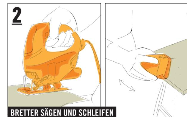
Das Brett (30x195x2500 mm) mit der Stichsäge zuschneiden auf 2 Stücke à 400 mm und 1 Stück à 300 mm. Schleifpapier um den Handschleifklotz wickeln und alle Schnittkanten schleifen, um Verletzungen zu vermeiden.
