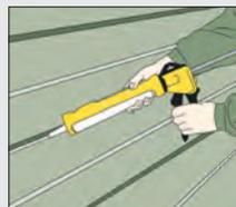
Pour un aspect opaque et uniformément fermé: sceller les espaces entre les éléments de plaques avec de l'acrylique extérieur. Température extérieure requise: à partir de 14 °C.
