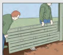
Mettre en place les plaques en béton jusqu'à l'arête supérieure des poteaux de bordure en les équilibrant. Caler les plaques individuelles.
