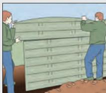
Poser les plaques en béton sur la fondation pour les soutenir. Important pour montage à double face.
