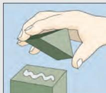
Nettoyer les murs (sans poussière et à sec). Monter les accessoires (couvre-poteau et barre supérieure) avec de la colle à carrelage.
