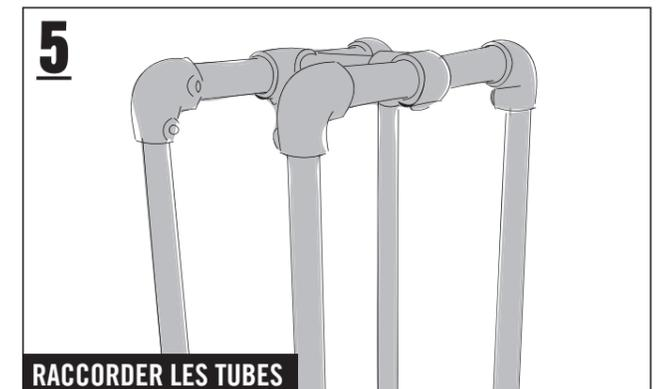
Poser maintenant les deux tubes de raccordement sur les quatre tubes. Raccorder les deux pièces en T courtes au milieu avec le tube de 130 mm et fixer toutes les pièces de raccordement avec la clé Allen BUILDIFY. Vérifier et resserrer les raccords à vis. Tu viens de faire des étincelles!
