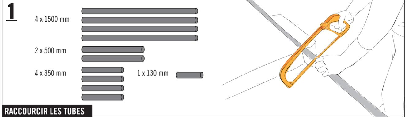
Porter des vêtements de protection adaptés pour les étapes de travail suivantes. Découper les trois tubes (3000 mm) avec la scie à métaux sur 4 x 1500 mm, 2 x 500 mm, 4 x 350 mm et 1 x 130 mm. Ebavurer les extrémités des tubes sciés à l'intérieur et à l'extérieur avec la lime demi-ronde pour éviter des blessures.
