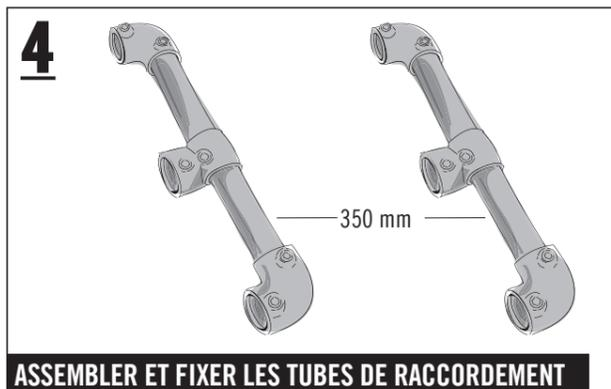
Poser une pièce en T sur les tubes restants de 350 mm de long au milieu. Poser deux pièces d'angle sur les extrémités et fixer avec la clé Allen BUILDIFY.
