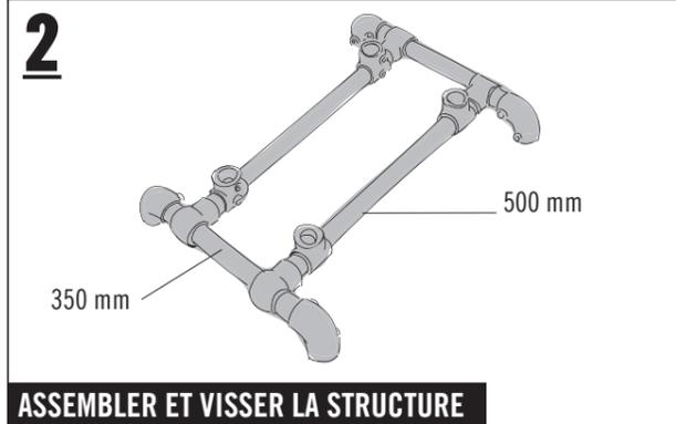
Assembler le piétement à partir de deux tubes de 350 mm de long et de deux tubes de 500 mm de long, quatre pièces d'angle et huit pièces en T. Laisser les pièces en T détachées pour les tubes longs verticaux, fixer les autres pièces en T et l'équerre avec la clé Allen BUILDIFY.
