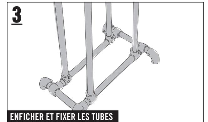
Raccourcir les quatre tubes (1500 mm) dans les quatre pièces en T courtes, orientées vers le haut, du piétement et fixer avec la clé Allen BUILDIFY.
