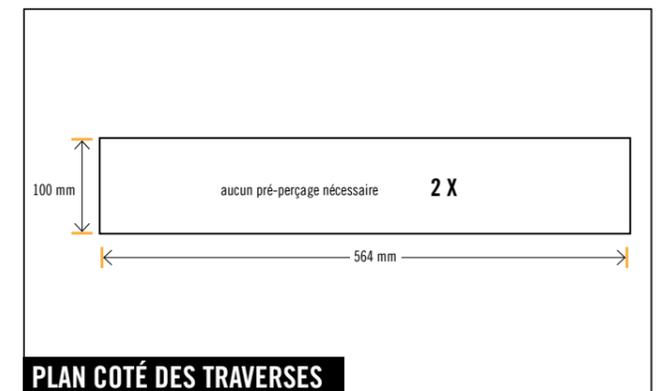
Tu visseras plus tard ces deux traverses avec les deux parois latérales, la traverse arrière également avec la paroi arrière.
