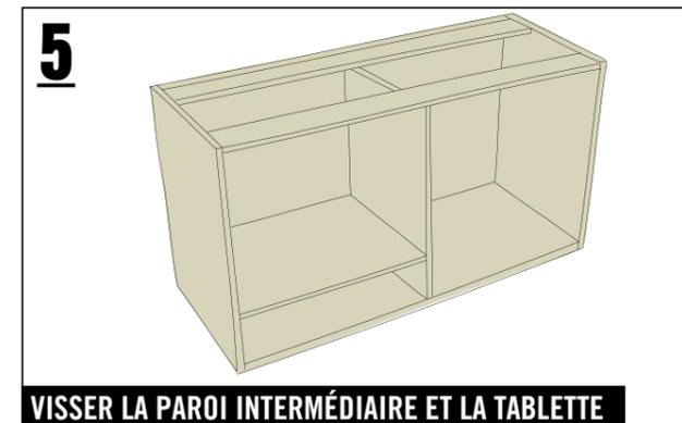
Faire glisser la paroi intermédiaire et la visser avec deux vis (4,5 x 40 mm) en haut aux traverses et avec quatre vis (4,5 x 40 mm) en bas à la dalle de sol. Visser ensuite la tablette avec la paroi latérale gauche et la paroi intermédiaire avec quatre vis à chaque fois (4,5 x 40 mm).
