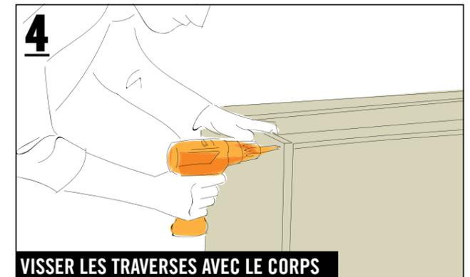
Placer les traverses à fleur entre les parois latérales à l'extérieur et en haut, et les visser aux parois latérales avec quatre vis (4,5 x 40 mm) chacune, la traverse arrière avec cinq vis supplémentaires (4,5 x 40 mm) avec la paroi arrière.
