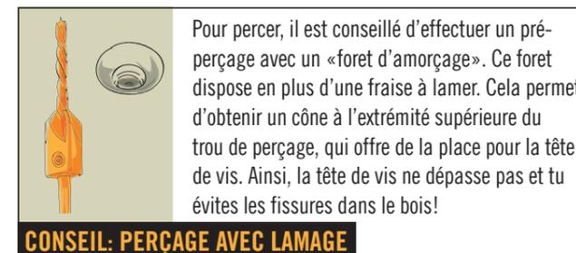
Pour percer, il est conseillé d'effectuer un pré-perçage avec un «foret d'amorçage». Ce foret dispose en plus d'une fraise à lamer. Cela permet d'obtenir un cône à l'extrémité supérieure du trou de perçage, qui offre de la place pour la tête de vis. Ainsi, la tête de vis ne dépasse pas et tu évites les fissures dans le bois!
