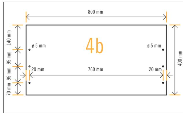
**PLAN DE TRAVAIL SUPÉRIEUR** Préparer le panneau sérigraphié «4b» de 18 mm au perçage des trous de vissage de 5 mm. Pour ce faire, colle du ruban de masquage aux endroits où les trous sont prévus et marque-les.
