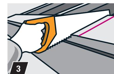
3 Dans les chevrons, scier des fentes de la largeur des supports de gouttière (illustr. 3). L'écart entre les supports de gouttière doit être de 50 à 80 cm.
