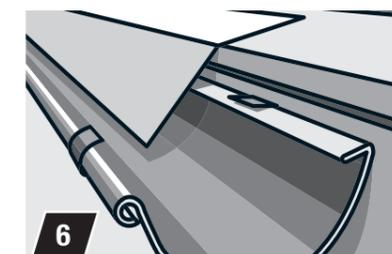
6 L'entrée de la gouttière offre une protection supplémentaire contre l'eau de pluie et la neige. Elle est suspendue dans le pli de la gouttière et fixée sur le lattis avec des pointes à tête large. Les supports de gouttière courts de 80 mm (c) peuvent être montés directement sur le débord de toit (illustr. 6).
