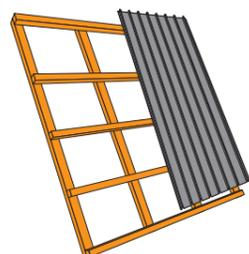
Si la tôle trapézoïdale est posée sur un ancien revêtement inégal non étanche, un lattis en bois est alors nécessaire pour l'évacuation de l'eau de condensation. Les lattes doivent éventuellement être calées afin d'obtenir une sous-toiture à niveau.
