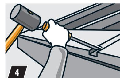
4 Creuser des encoches (illustr. 4) pour pouvoir insérer les fers de façon alignée dans les chevrons. Avant de les fixer, les supports de gouttière longs doivent être courbés. Le plus simple pour les courber est d'utiliser une grande tenaille ou un étau.
