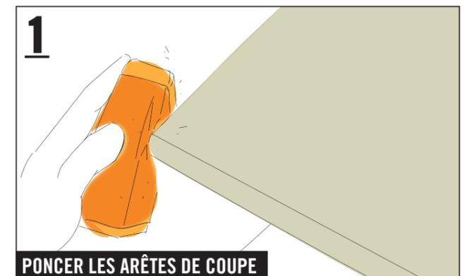
Enrouler le papier abrasif autour d'un bloc de ponçage et poncer les bords, jusqu'à ce que tous les endroits rugueux soient lisses.
