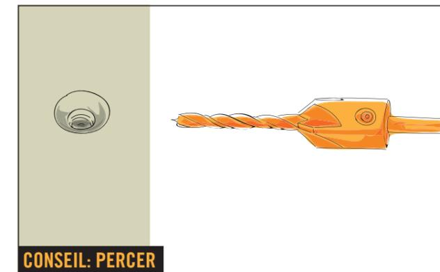
Pour percer, il est conseillé d'effectuer un pré-perçage avec un foret d'amorçage avec fraise. Cela permet d'obtenir un cône à l'extrémité supérieure du trou de perçage, qui offre de la place pour la tête de vis. Ainsi, la tête de vis ne dépasse pas et tu évites les fissures dans le bois!
