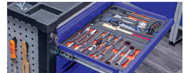
La capacité de charge par tiroir est de 35 kg. Ils sont entièrement extractibles avec des rails de guidage souples montés sur roulements à billes. Le blocage sélectif permet d'ouvrir un seul tiroir à la fois.
