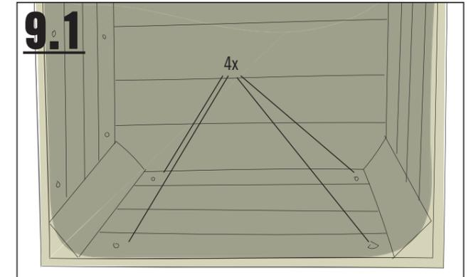
Fixez la caisse gauche à l'aide de quatre vis (4,5x25 mm).
