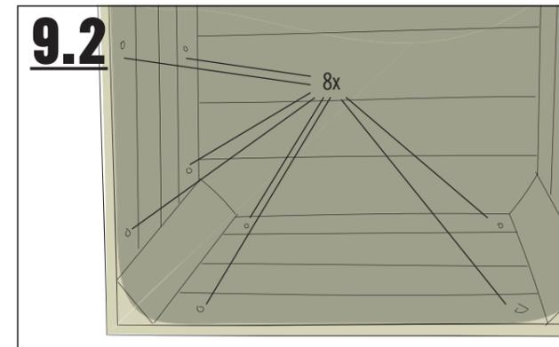
Fixez la caisse droite sur la palette à l'aide de quatre vis (4,5x25 mm) et à la caisse adjacente à l'aide de quatre vis (4,5x20 mm).
