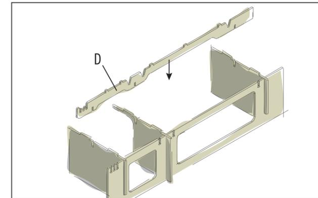
Relie les trois éléments de paroi à l'aide de l'étau (D). L'étau est posé sur le côté, par dessus les deux faces.
