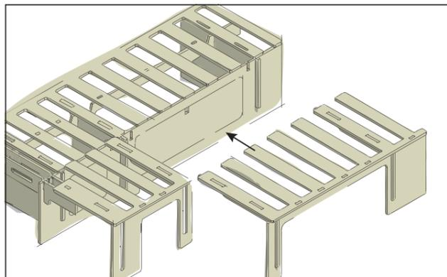
Pose également l'élément gigogne large. Replié, on obtient une surface plane sur laquelle tu peux t'asseoir, et déplié, un lit.
