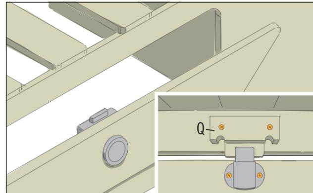
La serrure pour meuble Push Lock est ensuite montée. Poser our cela par l'intérieur, la butée fournie (Q) avec la Campingbox adaptée à la serrure pour meuble Push Lock. 4 vis à tête fraisée de 3 x 16 mm sont nécessaires.
