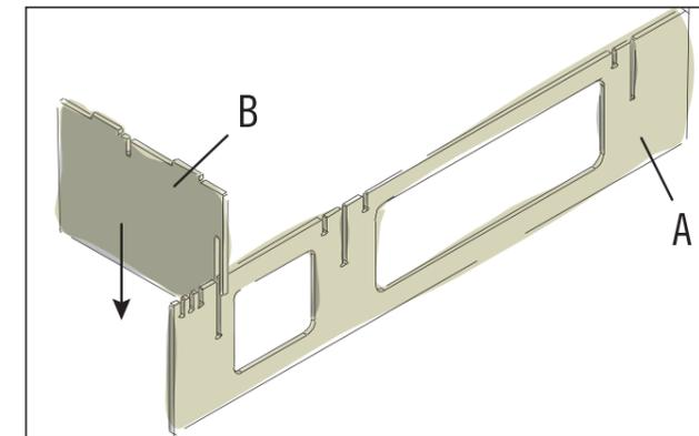
Pose la façade (A) debout et emboîte le premier élément de paroi (B) dans la fente gauche de la façade.
