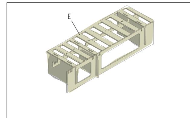
Pose le panneau de recouvrement à lattes (E) sur la partie inférieure montée précédemment, de manière à ce que tous les tenons s'insèrent correctement dans les rainures pré-découpées du panneau de recouvrement. Appuie fort sur le panneau de recouvrement.
