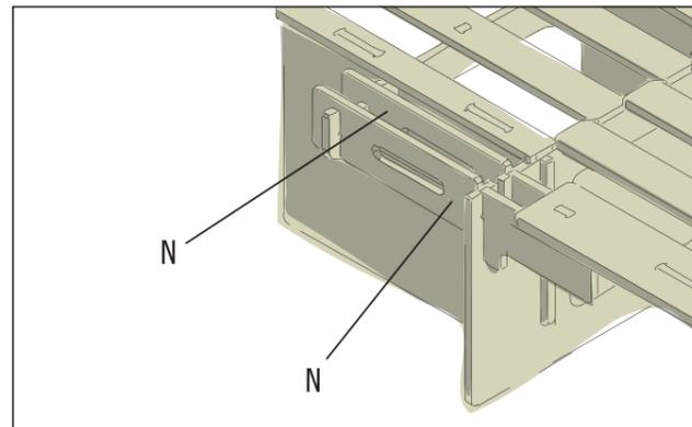
Insère les deux cales (N) dans les rainures de l'étau (D) placé au dessus et de la façade.
