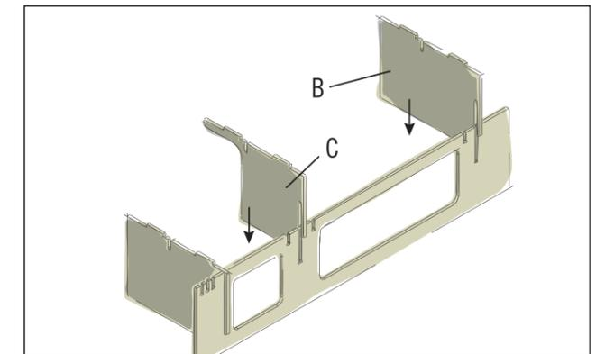
Emboîte le deuxième élément de paroi (B) dans la fente arrière et dans la fente du milieu la paroi intermédiaire (C). Les éléments doivent ensuite être alignés en haut.
