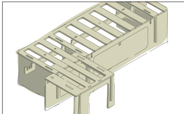
Pose l'élément gigogne court à l'extrémité gauche du cadre et sors-le en le tirant vers l'avant.
