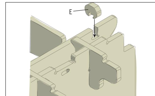
et le panneau avant puissent être poussés jusqu'à l'étau (B2). Teste le fonctionnement et corrige les pièces si besoin. Si les pièces ne s'emboîtent pas complètement, la partie gigogne coince.
