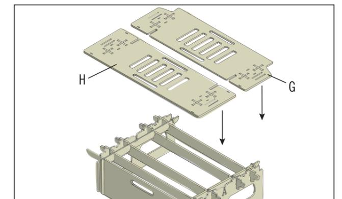
Repousse le panneau avant en arrière. Emboîter maintenant le panneau de recouvrement (G) sur la pièce inférieure du bord arrière, de manière à ce que les fentes des angles soient orientées vers l'extérieur. Placer le panneau de recouvrement (H) dans l'alignement et l'emboîter également.
