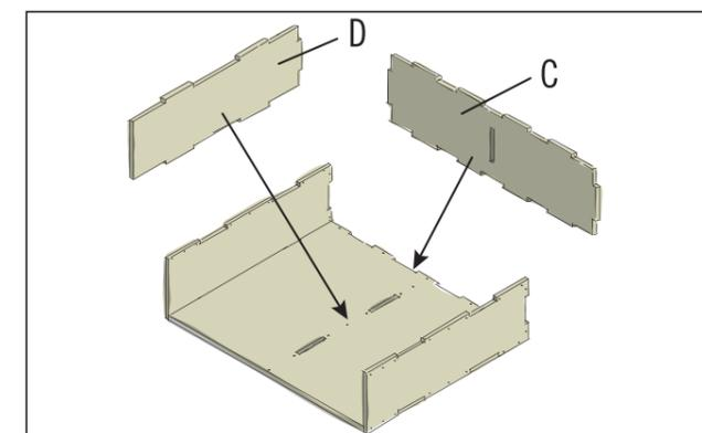
Emboîter aussi le panneau arrière (C) et la paroi intermédiaire (D) dans les fentes et visser depuis la face inférieure du panneau de fond. Visser ensuite les parois latérales à la paroi arrière dans les trous de perçage prévus à cet effet. Terminer par le vissage de la paroi intermédiaire au panneau de fond et à la paroi arrière.
