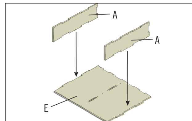
Pour visser toutes les pièces de bois du cadre des tiroirs, utiliser des vis de 3,5 x 35 mm. Insérer les deux parois latérales (A) dans les fentes du panneau de fond (E). Placer l'ensemble debout et visser les parois latérales par le bas, dans les trous de perçage en place dans le panneau de fond. Visser également les parois latérales au panneau de fond par l'extérieur.
