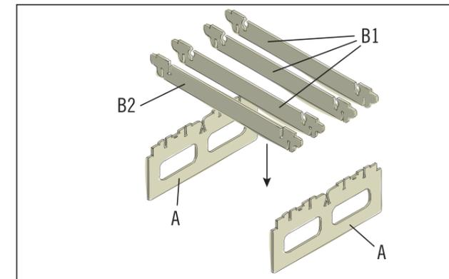
Avec l'aide d'une seconde personne, pose les deux parois latérales (A). Insère alors les trois étais (B1) et l'étau (B2) par le haut, dans les fentes des parois latérales.
