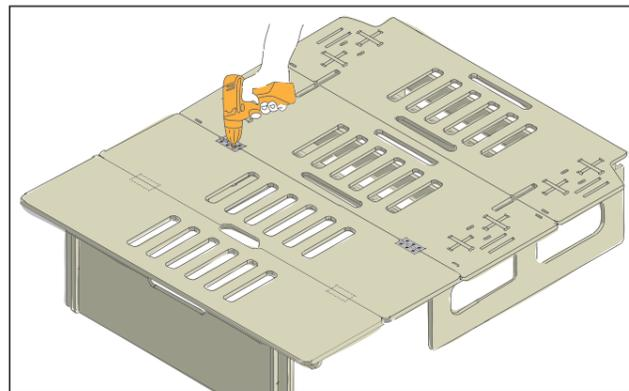
Retourner les deux panneaux et les visser aux panneaux de recouvrement emboîtés précédemment à l'aide de deux charnières et des vis de 3 x 16 mm.
