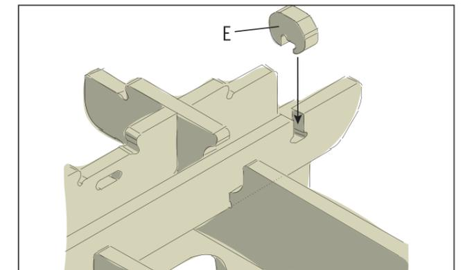
Un butoir (E) est inséré à l'extrémité de chacun des deux étais coudés. Il doit être positionné de manière à ce que les étais coudés
