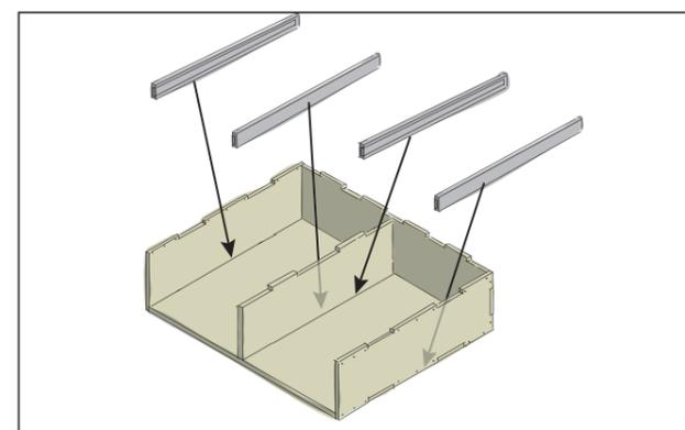
Deux coulisses pour tiroir doivent être montées dans chacun des deux compartiments de tiroir. Les coulisses ont une largeur de 19 mm. Placez-les de préférence en bas sur le fond du corps. C'est à cet endroit qu'elles sont le plus faciles à installer.
