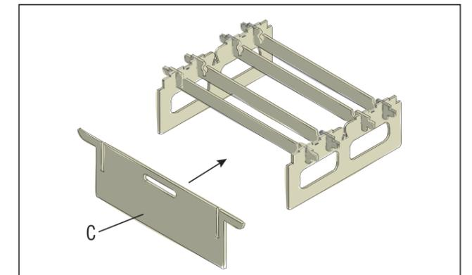
Emboîter le panneau avant (C) à l'avant dans les fentes des angles des parois latérales.
