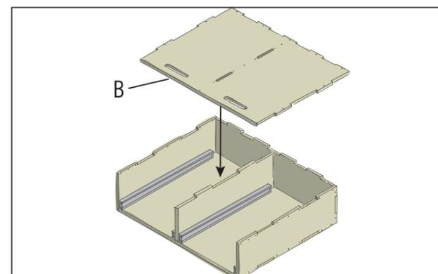
Après l'installation des coulisses pour tiroir, le cache du cadre (B) peut être monté et fixé à la paroi intermédiaire, aux parois latérales et à la paroi arrière à l'aide de vis de 3,5 x 35 mm.
