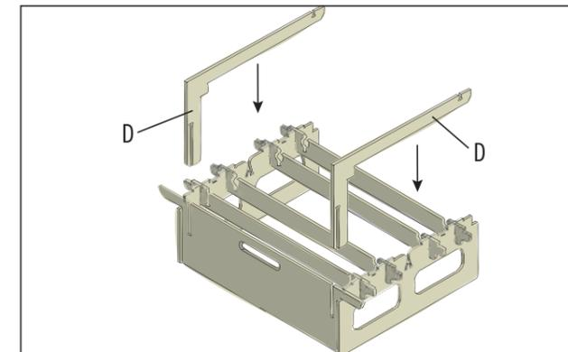
Introduire les deux étais coudés (D) dans les fentes du panneau avant. Insérer pour cela les parties longues des étais coudés dans les fentes supérieures des étais (B1 et B2).
