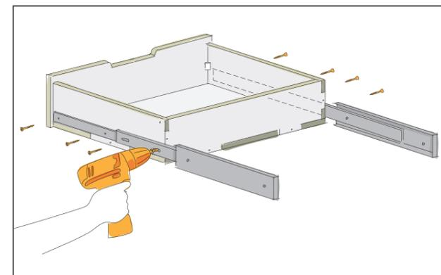
Deux coulisses sont fixées aux tiroirs. Sépare complètement les coulisses et visse-les avec des vis à tête fraisée de 4 x 16 mm au travers de la partie centrale de la coulisse, directement au-dessus du panneau du bas du tiroir. Puis visser également la partie avant de la coulisse au niveau du tiroir. Veille à ce que les coulisses soient bien parallèles aux tiroirs.
