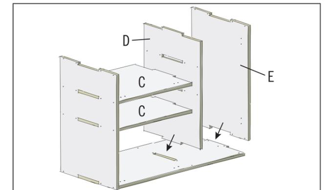
Insère les deux tablettes (C) dans les fentes de la paroi latérale. Insère définitivement la paroi intermédiaire (D) et la paroi latérale (E) dans la fente du panneau du bas. Le vissage de la paroi intermédiaire se fait avec des vis à tête fraisée de 3,5 x 35 mm sur les tablettes du meuble. La paroi latérale (E) peut désormais également être insérée dans le tenon du panneau du bas et vissée comme précédemment. Visse ensuite les vis à travers le panneau du bas dans les parois, par en dessous.
