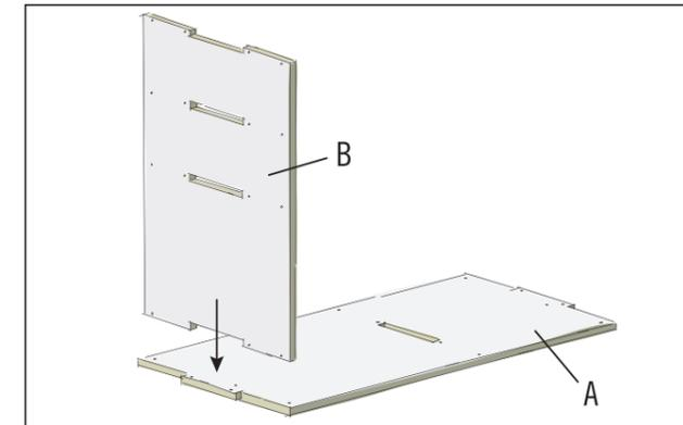
Poser le panneau du bas (A) sur un support plat et insérer la première paroi latérale (B) dans le tenon au bord du panneau du bas. Les deux évidements oblongs de la paroi latérale se trouvent en haut.
