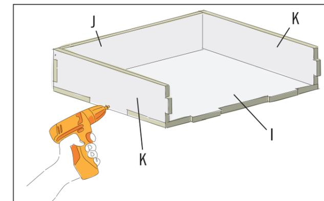
Visse les deux parois latérales (K) et la paroi arrière (J) dans le panneau de fond (I). Les vissages s'effectuent par le côté dans le panneau de fond puis au travers du panneau de fond dans les parois. Utiliser pour cela des vis à tête fraisée 3,5 x 35 mm.
