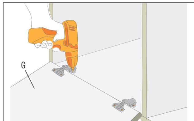
Fixe les portes du meuble (G), (H) et (M) avec les charnières invisibles, dans les trous de fixation préalablement percés dans le corps du meuble. Utilise des vis à tête fraisée de 3 x 16 mm.
