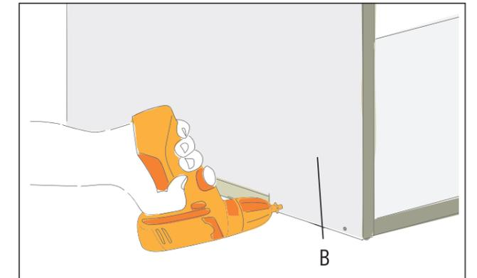
Visse la paroi latérale (B) avec des vis à tête fraisée de 3,5 x 35 mm à travers les trous de vis pré-perçés. Après avoir vissé les vis latérales, deux autres vis à tête fraisée de 3,5 x 35 mm sont vissées par en-dessous, dans la paroi latérale, à travers les tenons.
