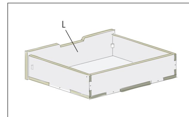
pré-perçés. Le panneau avant (L) peut être fixé aux tenons des parois latérales et du panneau de fond et vissé au raccord d'angle.
