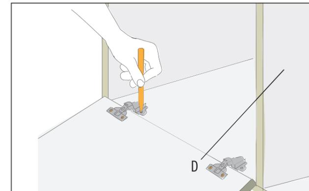
Prépare maintenant les trous de fixation des portes sur le corps du meuble. Pour cela, monte les charnières invisibles sur les portes (G), (H) et (M). Place chaque porte sur les emplacements de montage et marque la position des vis à travers les plaques de montage des charnières.
