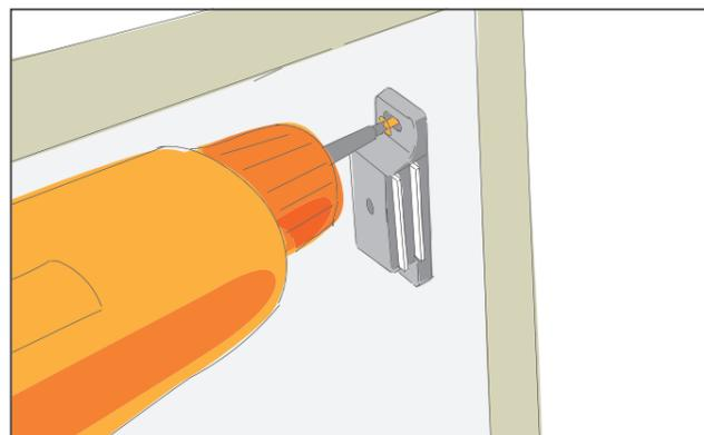
Des clips magnétiques sont montés aux endroits marqués pour faire office de butée. Les plaques métalliques jointes sont fixées sur les portes de manière à ce qu'elles soient maintenues par les aimants.
