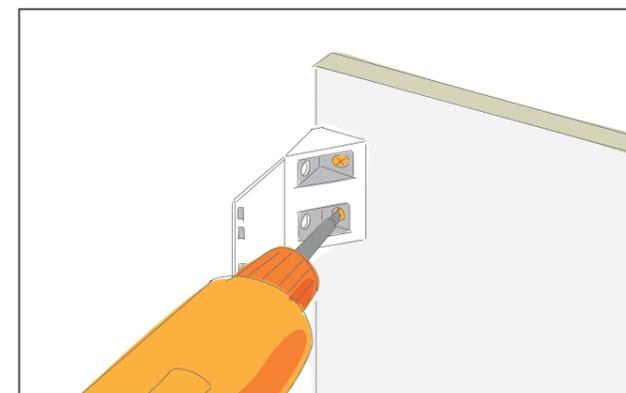
Pour pouvoir fixer le panneau avant, un raccord d'angle universel doit être vissé de chaque côté. Les raccords d'angle sont alignés devant avec le bord de la paroi latérale. Visse-les avec des vis à tête fraisée de 3 x 16 mm. Les trous de vissage n'ont pas besoin d'être
