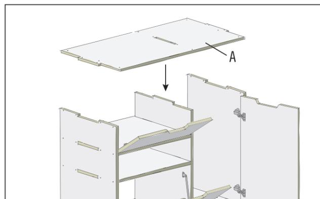
Poser maintenant l'élément couvrant (A) sur les parois – il est identique au panneau du bas (A) – et le visser par le dessus, à travers les trous de vis prévus. Visse également le panneau au travers des deux parois latérales. Les vissages se font avec des
