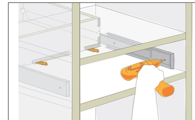
Rentre le tiroir dans l'ouverture du meuble et cale-le avec des cales de 2 mm d'épaisseur. Visse la partie la plus épaisse à l'arrière des coulisses aux parois latérales de l'ouverture du meuble. Utilise des vis à tête fraisée de 4 x 16 mm. Veille à ce que les coulisses soient bien parallèles à l'ouverture du meuble et que le tiroir s'ouvre et se ferme sans difficulté.
