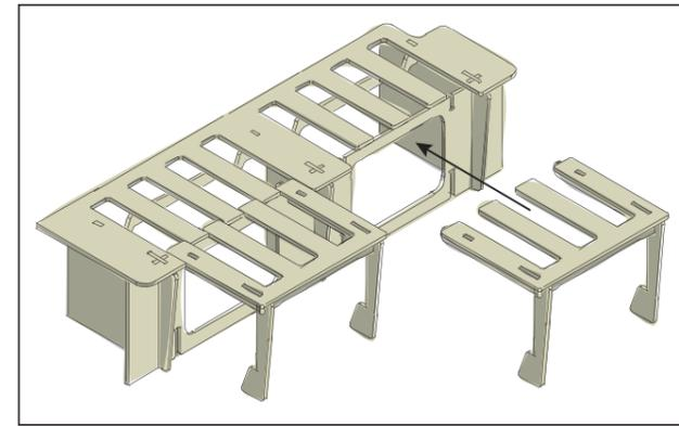
Raccorde les deux éléments gigognes avec le cadre. Les lattes du panneau de recouvrement s'insèrent exactement. Tu peux sortir les éléments gigognes jusqu'au butoir.
