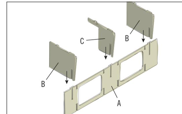
Assemble les deux éléments de paroi (B) à l'extérieur et l'élément
