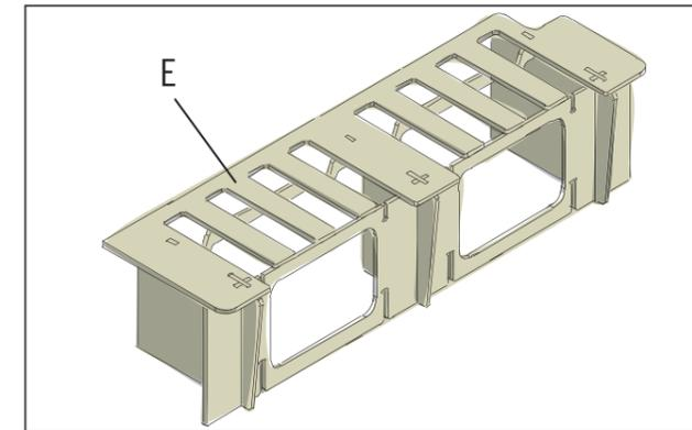
Pose le panneau de recouvrement à lattes (E) sur la partie inférieure
