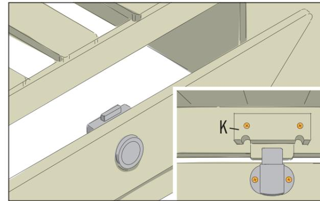
La serrure pour meuble Push Lock est ensuite montée. Poser pour cela par l'intérieur, la butée fournie (K) avec la Campingbox adaptée à la serrure pour meuble Push Lock. 4 vis à tête fraisée de 3 x 16 mm sont nécessaires.
