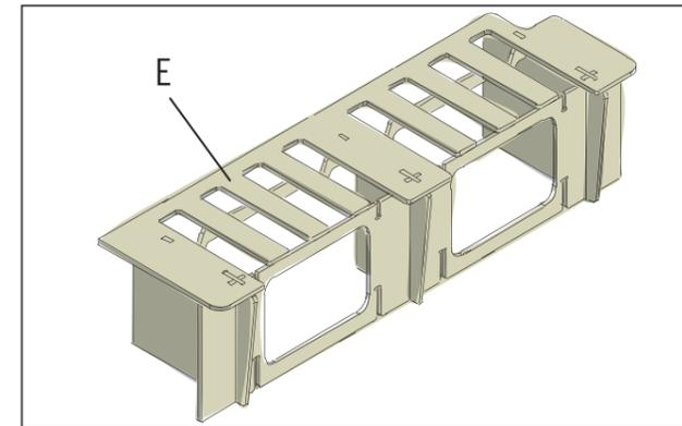
Pose le panneau de recouvrement à lattes (E) sur la partie inférieure montée et emboîte-le aux tenons qui montent.
