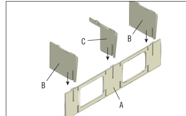
Assemble les deux éléments de paroi (B) à l'extérieur et l'élément de paroi (C) au centre avec la façade (A). Emboîte pour cela les éléments dans les fentes prévues à cet effet.
