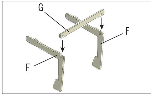
Deux éléments gigognes sont nécessaires. Les deux éléments sont identiques. Relie les deux éléments angulaires (F) en haut à l'aide de l'étai (G).
