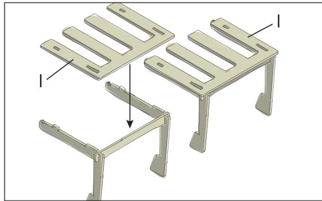
Emboîte un panneau de recouvrement à lattes (I) sur chacune des parties inférieures montées précédemment. Pour faciliter l'emboîtement, les éléments peuvent être tournés de 180°.
