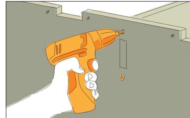
Visser tous les éléments du corps du placard au niveau des trous de perçage en place à l'aide de vis de 3,5 x 35 mm.
