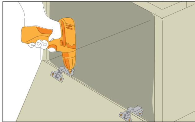
Chacune des deux portes se fixe au moyen de deux charnières invisibles aux ouvertures prévues à cet effet. Les charnières sont vissées à l'aide de vis de 3 x 16 mm.
