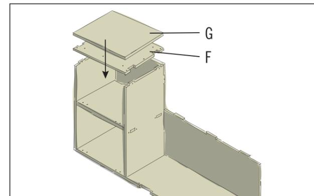
Emboîter le panneau de recouvrement (F) et le visser aux éléments de paroi et à la paroi arrière. Le panneau de recouvrement compte 6 trous de perçage sur sa face arrière et 3 sur l'avant. Poser le panneau de recouvrement sur le plan de travail (G). Celui-ci n'a aucun trou de perçage.
