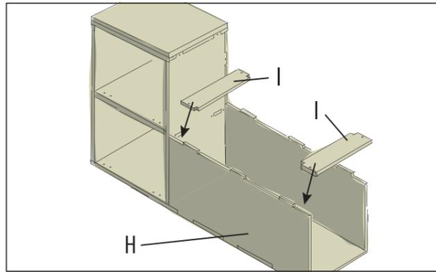
Emboîter le panneau avant (H) avec le panneau du bas. Poser les deux planches de raccordement (I) à gauche et à droite sur le corps et visser par le haut sur la face arrière et le panneau avant. Basculer l'ensemble du corps sur la gauche afin de visser le panneau avant sur le fond.
