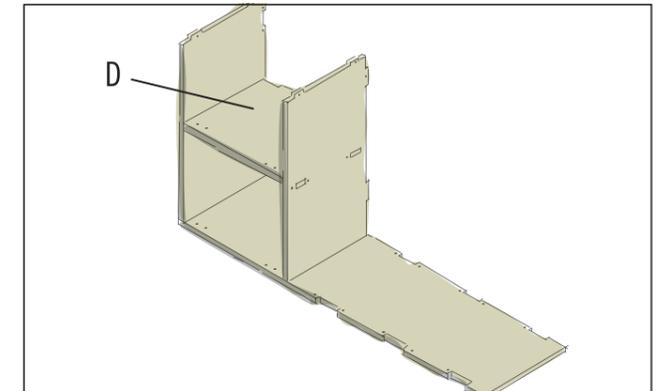
Écarter légèrement les deux éléments de paroi et emboîter le panneau intermédiaire (D) dans les fentes.
