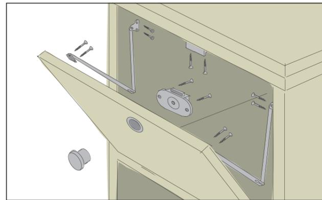
Monter la serrure pour porte sur chaque porte comme indiqué, en utilisant des vis à tête fraisée de 3 x 16 mm. Deux compas d'abat-tant sont installés sur les côtés de chaque porte. Ils sont à fixer avec les vis fournies.
