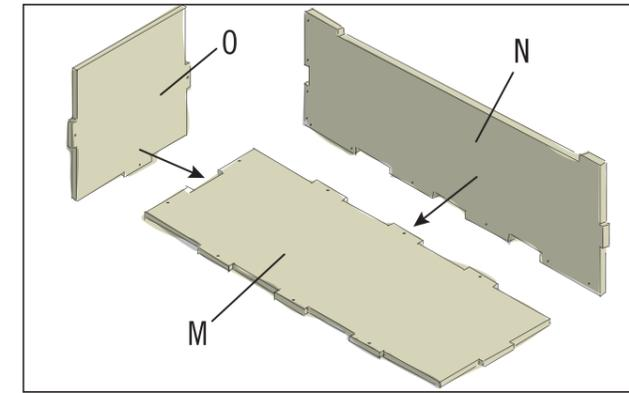
Assembler le panneau du bas (M) et les éléments de paroi (N et O) aux fentes prévues à cet effet et visser. Le vissage s'effectue sur le côté et par le bas à travers le panneau du bas.
