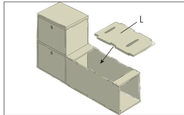
Le cache (L) peut être posé à l'essai. Il reste ensuite sans fixation pour pouvoir être retiré afin de remplir le tiroir.
