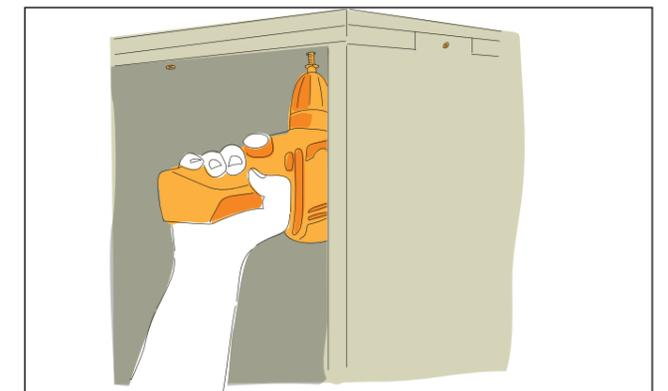
Visser le plan de travail par le bas à travers les trous de perçage du panneau de recouvrement à l'aide de vis de 3 x 25 mm.
