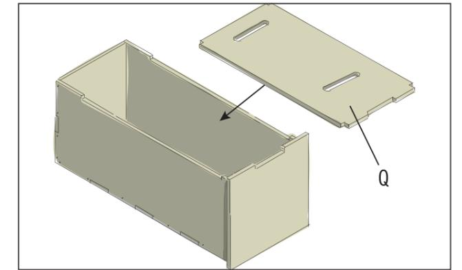
Le cache (Q) est simplement posé sans fixation, c'est à dire, sans être vissé. Il peut être retiré facilement au niveau des fentes des poignées afin de remplir le tiroir. Il ne reste plus qu'à monter les coulisses pour tiroir.
