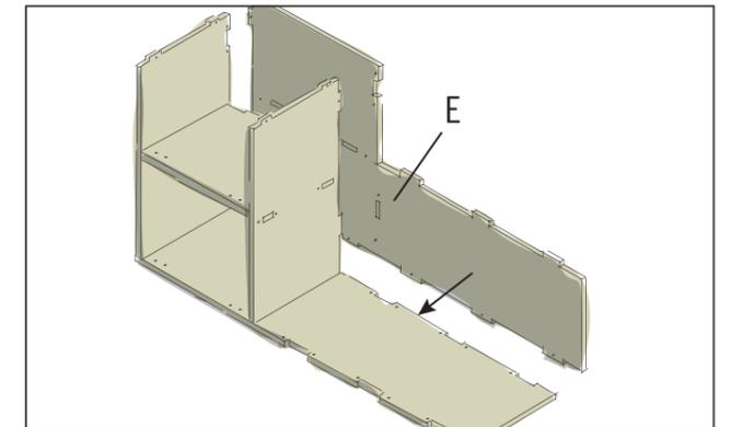
Remettre le corps en position debout. Monter la paroi arrière (E) par l'arrière. Les tenons et les fentes doivent s'insérer les uns dans les autres. Visser la paroi arrière au niveau des trous de perçage prévus à cet effet.
