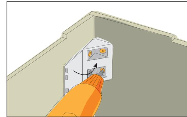
Visser l'avant du tiroir sur chacun des deux éléments de paroi par l'intérieur à l'aide de deux raccords d'angle et des vis de 3 x 16 mm.
