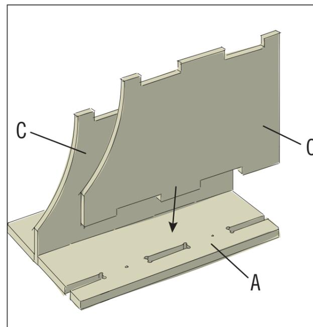
Pose la paroi latérale courte (A) sur une surface plane. Insérer ensuite les deux étagères avec les tenons dans les fentes. Remarque: l'étagère peut également être montée à l'envers, il suffit pour cela d'insérer les deux étagères en les tournant de 180°.
