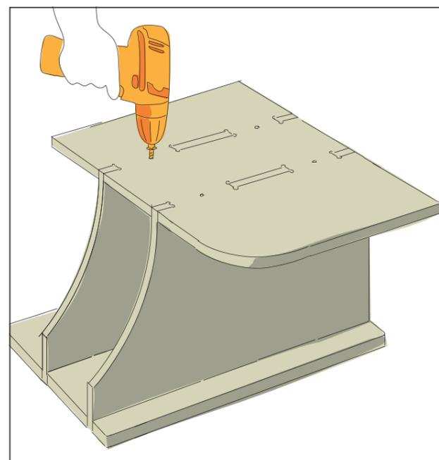
Visse une vis à tête fraisée de 3,5 x 35 mm dans chacun des trous de vis existants. Visser les vis de sorte à ce que la tête de vis soit alignée avec la surface en bois.
