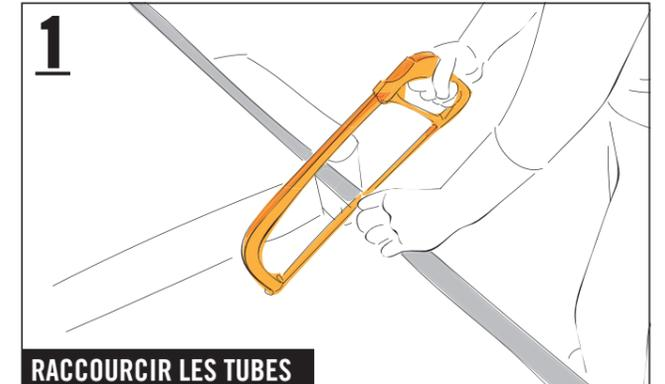
Porter des vêtements de protection adaptés pour les étapes de travail suivantes. Raccourcir les deux tubes (3000 mm) avec la scie à métaux conformément aux indications concernant la découpe des tubes. Ebavurer les extrémités des tubes sciés à l'intérieur et à l'extérieur avec la lime demi-ronde pour éviter des blessures.
