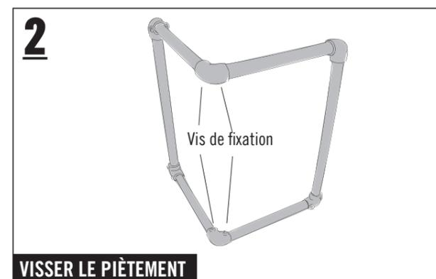
A partir de quatre tubes courts (380 mm) et deux tubes longs (640 mm) et six pièces angulaires, assembler le piètement – les vis des pièces angulaires inférieures doivent apparaître en haut, celles des pièces angulaires supérieures en bas. Il convient ensuite de serrer toutes les vis à l'aide de la clé Allen BUILDIFY.
