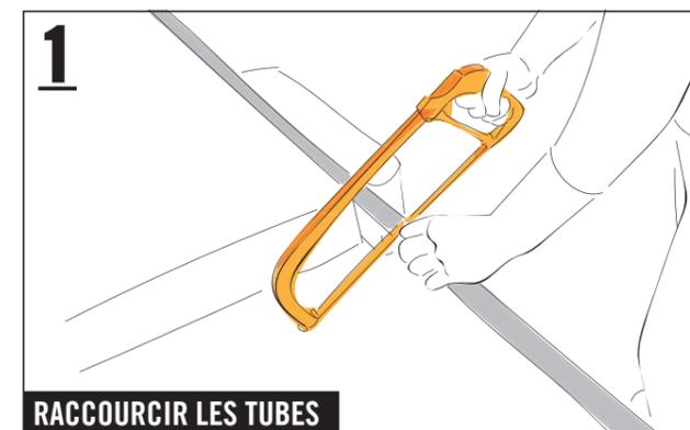
Porter des vêtements de protection adaptés pour les étapes de travail suivantes. Découper deux tubes (1000 mm) à l'aide de la scie à métaux sur 800 mm et un tube sur 2 x 500 mm. Ebavurer les extrémités des tubes sciés à l'intérieur et à l'extérieur avec la lime demi-ronde pour éviter des blessures.
