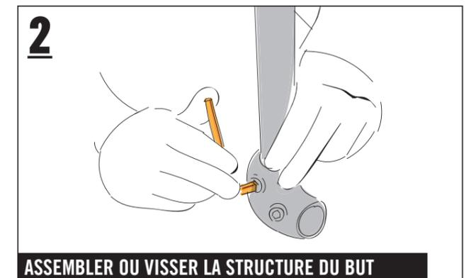
Assembler le piètement du but à partir des tubes et des pièces d'angle (voir dessin en haut à gauche). Fixer les tubes dans les pièces d'angle avec la clé Allen BUILDIFY.
