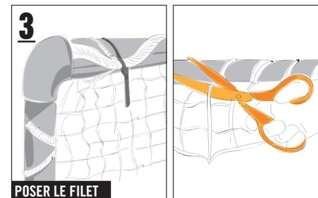
Poser le filet au-dessus du piètement du but, aligner et fixer à l'aide d'un serre-câbles sur les tubes tous les 10 à 20 cm. Veille à ce que les languettes des serres-câbles se situent sur la face arrière du but et soient alignées par rapport au filet. Découper ensuite le filet qui dépasse à l'aide des ciseaux.
