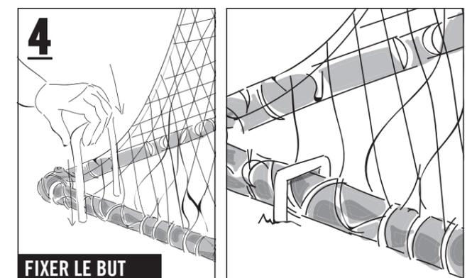
Place les 10 anneaux métalliques à des intervalles identiques au-dessus des tubes au sol et enfonce-les dans le support jusqu'à ce que le but soit stable. Et maintenant jouons.
