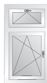
Einflügeliges Fenster mit Dreh-Kipp-Mechanismus und Oberlicht-Kipp
