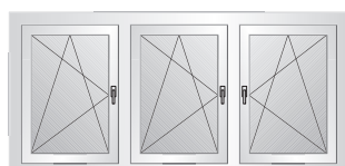
Dreiflügeliges Fenster mit Dreh-Kipp-Mechanismus
