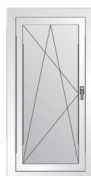
Einflügelige Balkontür mit Dreh-Kipp- Mechanismus
