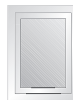
Einflügeliges Fenster fest im Blendrahmen verglast/ Fenster mit eingeschraubtem Flügel
