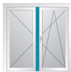
Zweiflügelige Balkontüren mit Dreh-Kipp-Mechanismus und beweglichen Pfosten
