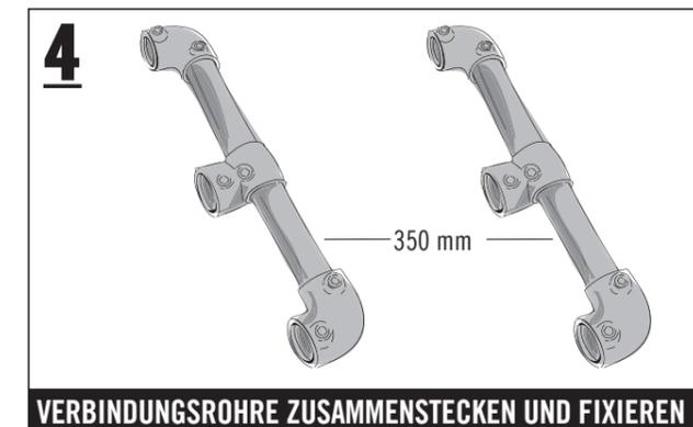
An den verbleibenden 350 mm langen Rohren jeweils in der Mitte ein T-Stück aufstecken. An den Enden jeweils zwei Winkelstücke aufstecken und mit dem Innensechskantschlüssel BUILDIFY fixieren.
