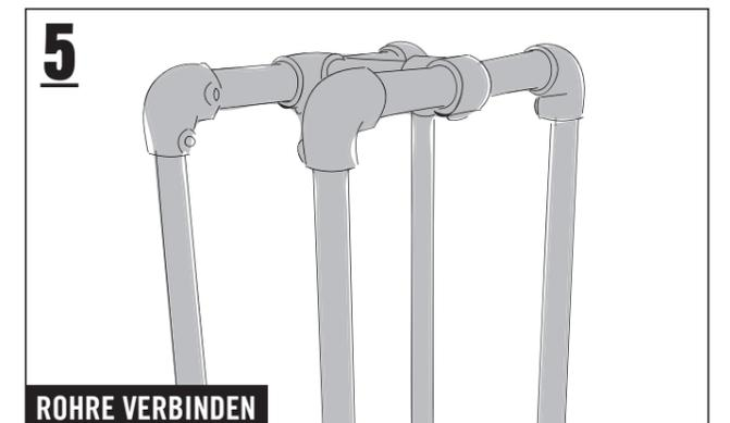
Nun die beiden Verbindungsrohre auf die vier Rohre stecken. Die beiden kurzen T-Stücke mittig mit dem 130 mm Rohr verbinden und alle Verbindungsstücke mit dem Innensechskantschlüssel BUILDIFY fixieren. Alle Schraubverbindungen überprüfen und nachziehen. Du hast gleich Feuer gemacht!
