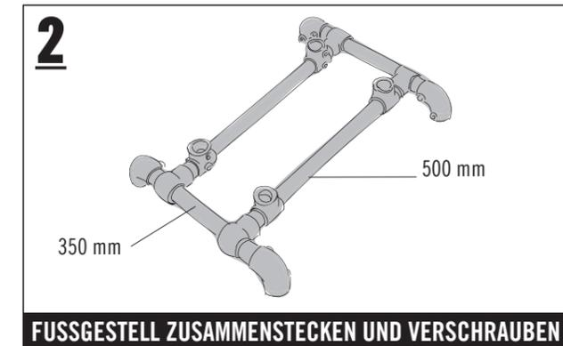
Das Fussgestell aus zwei 350 mm und zwei 500 mm langen Rohren, vier Winkelstücken und acht T-Stücken zusammenstecken. Die T-Stücke für die langen senkrechten Rohre erst einmal lose lassen, die übrigen T-Stücke und die Winkel mit dem Innensechskantschlüssel BUILDIFY fixieren.
