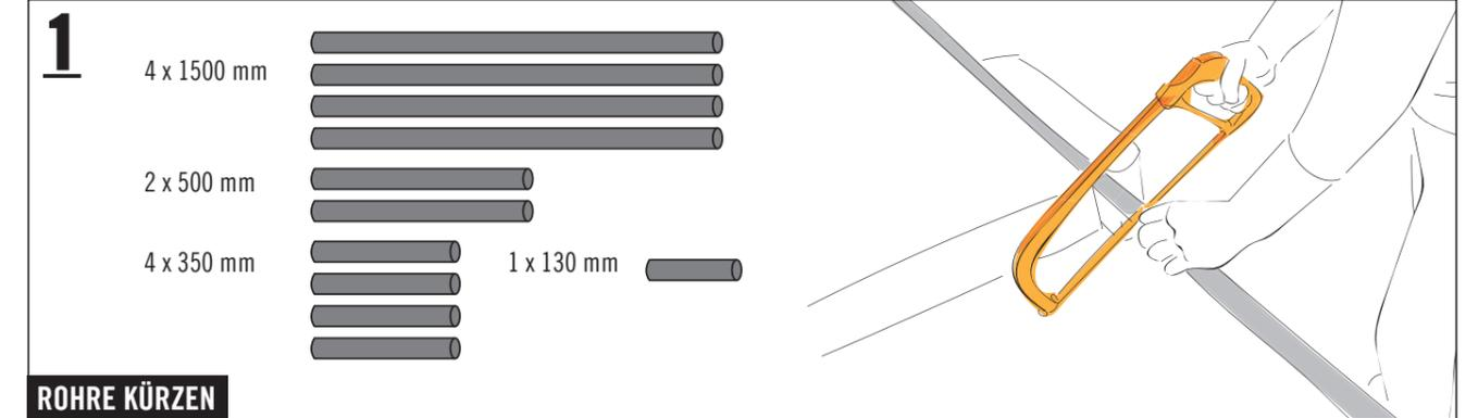
Trage für die folgenden Arbeitsschritte geeignete Schutzhandschuhe. Die drei Rohre (3000 mm) mit der Metallsäge zuschneiden auf 4 x 1500 mm, 2 x 500 mm, 4 x 350 mm und 1 x 130 mm. Die Enden der abgesägten Rohre innen und aussen mit der Halbrundfeile entgraten, um Verletzungen zu vermeiden.
