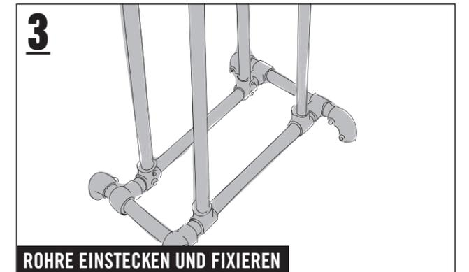
Die vier Rohre (1500 mm) in die vier kurzen, nach oben gerichteten T-Stücke des Fussgestells stecken und mit dem Innensechskantschlüssel BUILDIFY fixieren.
