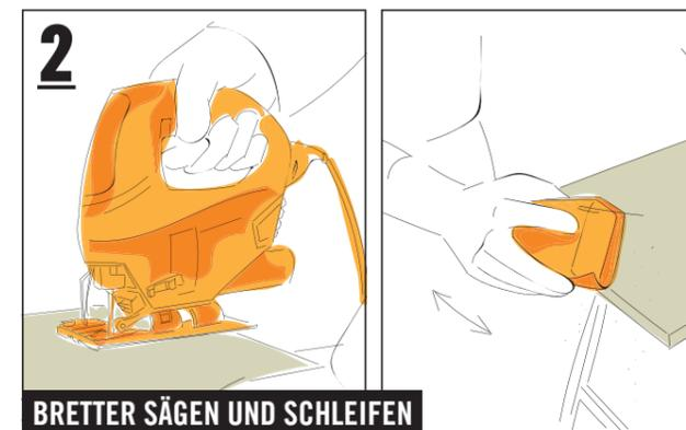
Die beiden Bretter (30x195x2500 mm) mit der Stichsäge zuschneiden auf 3 Stücke à 1100 mm und 2 x Stücke à 500 mm. Schleifpapier um den Handschleifklotz wickeln und alle Schnittkanten schleifen, um Verletzungen zu vermeiden.
