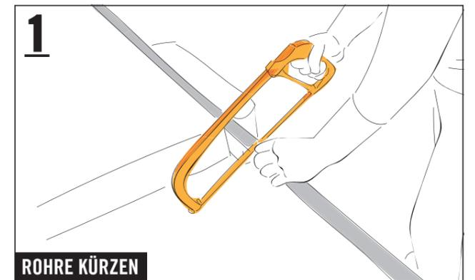
Trage für die folgenden Arbeitsschritte geeignete Schutzhandschuhe. Zwei Rohre (1000 mm) mit der Metallsäge halbieren, um vier Rohre (500 mm) zu erhalten. Die Enden der abgesägten Rohre innen und aussen mit der Halbrundfeile entgraten, um Verletzungen zu vermeiden.
