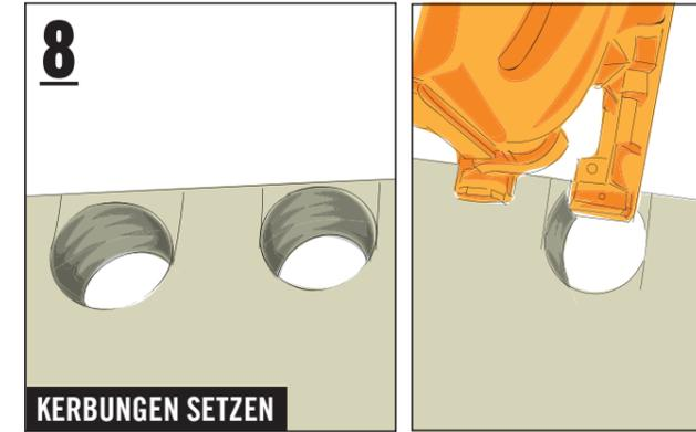
Vom Rand der gebohrten Löcher jeweils zwei Markierungen senkrecht zur Brettkante einzeichnen. Mit der Stichsäge entlang der Markierung sägen, um drei geöffnete Kerben zu erhalten. Danach die Kerben mit Schleifpapier glätten.
