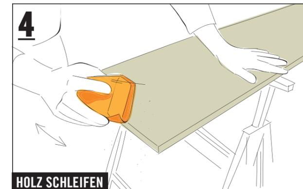
Schleifpapier um einen Handschleifklotz wickeln und Ecken, Kanten sowie Oberflächen schleifen, bis alle rauen Stellen glatt sind. Nach dem Grundieren stellen sich durch die Feuchtigkeit oft feine Holzfasern wieder auf. Die werden mit einem zweiten Schliff entfernt.
