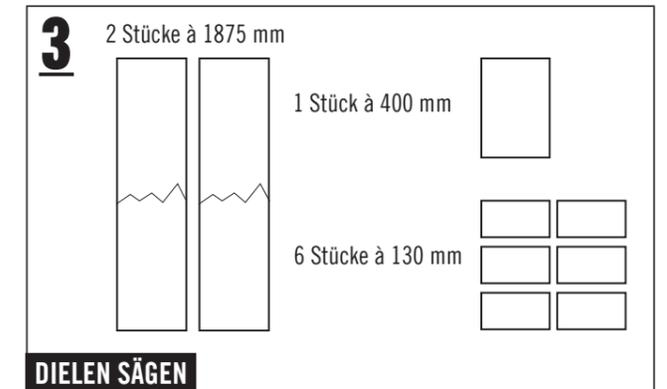
Die beiden Baudielen (40x200x3000 mm) mit der Stichsäge zuschneiden auf 2 Stücke à 1875 mm, 6 Stücke à 130 mm und 1 Stück à 400 mm.
