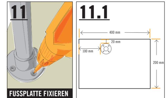
Die Fussplatte mit vier Schrauben (4,5x30 mm Pan-Head) und vier Unterlegscheiben (M3) auf der verbleibenden Diele (400 mm lang) entsprechend der Skizze verschrauben (Bild 11.1), die Abdeckkappe mit einem Hammer am Ende des Tischbeins einschlagen und ...
