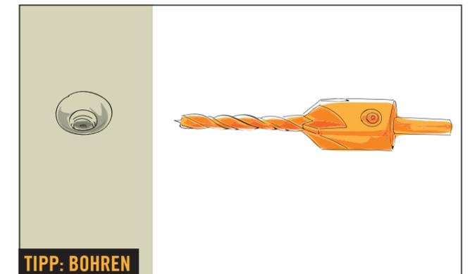
Für das Bohren empfiehlt sich ein «Vorböhrer mit Senker». Dieser sorgt für konische Bohrlöcher, in denen die Schraubenköpfe später perfekt versenkt werden können. Der Schraubenkopf steht dadurch nicht über, und Du vermeidest Risse im Holz!
