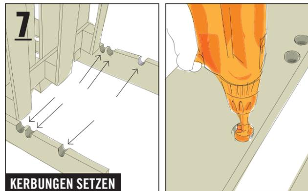
Unter dem Kopfteil in jede der beiden langen Dielen (1875 mm) entsprechend der Bohrskizze mit dem Forstnerbohrer (40 mm) drei Löcher bohren. Diese dienen später zum Verstellen der Rückenlehne.
