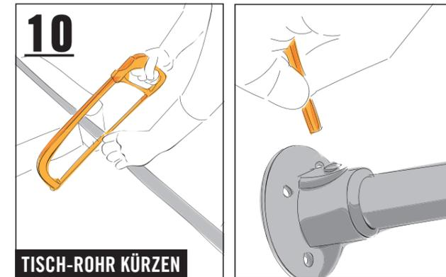
Das zweite Rohr (1000 mm) mit der Metallsäge auf 350 mm kürzen und die Schnittkanten innen und aussen mit der Halbrundfeile entgraten, um Verletzungen zu vermeiden. Dann an einem Ende des Rohrs mit dem Innensechskantschlüssel BUILDIFY die Fussplatte festschrauben.
