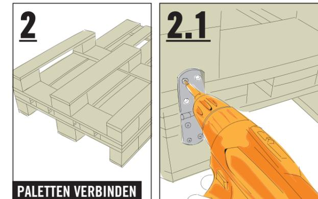
Das gekürzte Palettenteil (675 mm) umgedreht und an drei Seiten bündig auf der Palette ausrichten (Bild 2). Danach die Palette und das Palettenteil mit den beiden Tischbändern und je 8 Schrauben (5,0x30 mm) verbinden (Bild 2.1).
