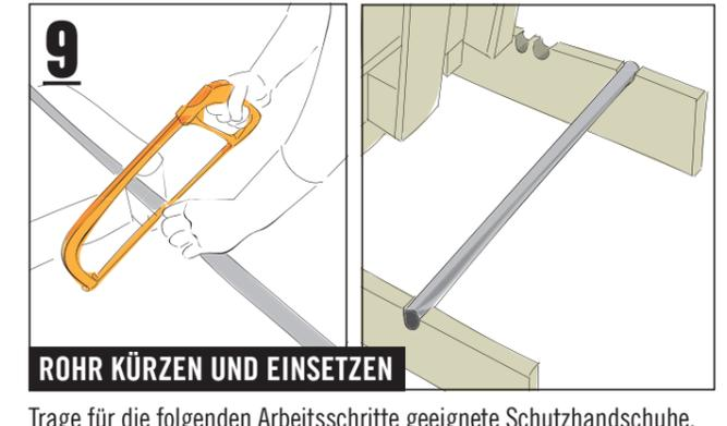
Trage für die folgenden Arbeitsschritte geeignete Schutzhandschuhe. Ein Rohr (1000 mm) mit der Metallsäge auf 960 mm kürzen, die Schnittkanten mit der Halbrundfeile innen und aussen entgraten, je eine Abdeckkappe mit einem Hammer in die Enden des Rohrs einschlagen und in die gewünschten Kerben legen.
