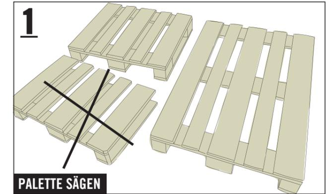
Eine der Paletten (144x800x1200 mm) mit der Holzäge an den mittleren Klötzen bündig durchsägen. Schleifpapier um den Handschleifklotz wickeln und die Schnittkanten des längeren Teils (144x800x675 mm) schleifen, um Verletzungen zu vermeiden.
