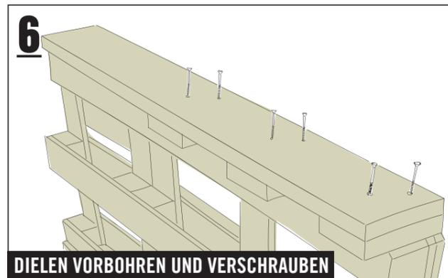
Die langen Dielen (1875 mm) bündig zur oberen Palettenkante ausrichten und mit jeweils sechs Schrauben (6,0x70 mm) auf den kurzen Dielen (130 mm) verschrauben.
