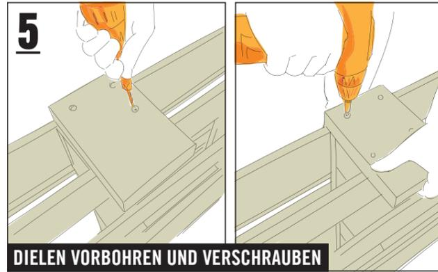
Die sechs kurzen Dielen (130 mm) entsprechend der Bohrskizze mit dem «Vorböhrer mit Senker» vorbohren. Die Dielen mit der kurzen Seite bündig zur oberen Palettenkante auf den Klötzen der langen Palette ausrichten und mit je vier Schrauben (6,0x70 mm) verschrauben.
