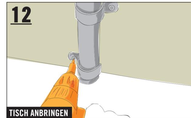
... das Rohr mit zwei Befestigungsbügeln und Schrauben (5,0x30 mm) als Ablagetisch an der gewünschten Stelle aussen an der Liege anbringen. Setze eine Schelle links und die andere Schelle rechts des Rohrs, um den Tisch zu stabilisieren – fertig. Und nun rauf auf Wolke sieben.
