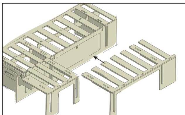
Setze das breite Ausziehelement ebenfalls auf. Im zusammengeschobenen Zustand entsteht eine ebene Fläche auf der Du sitzen kannst und im ausgezogenen Zustand ein Bett.
