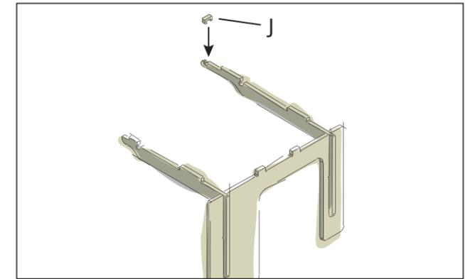
Entferne am Stopper (J) wie zuvor die kleinen Stege mit Schleifpapier. Setze den Stopper in die hintere Nut der Winkelstrebe (H) ein.
