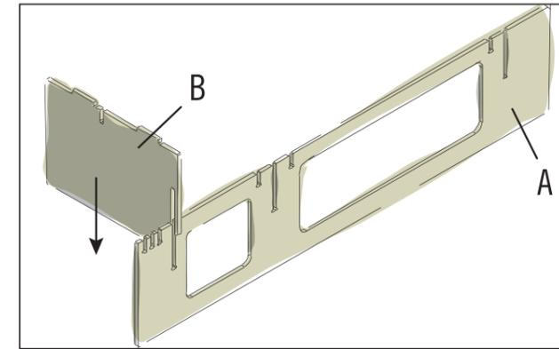
Stelle die Frontseite (A) auf und stecke das erste Wandelement (B) in die linke Aussparung der Frontseite ein.
