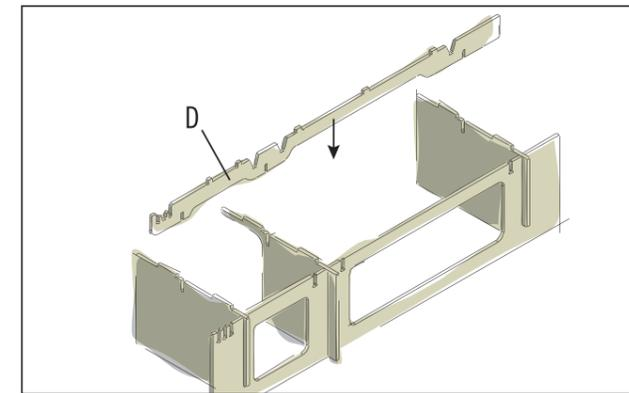
Verbinde mit der Strebe (D) die drei Wandelemente. Die Strebe steht seitlich auf beiden Seiten über.
