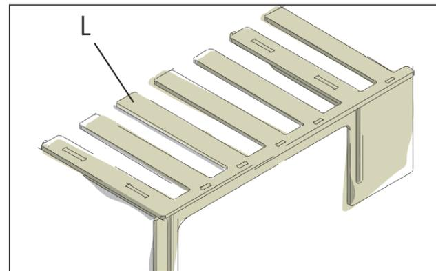
Stecke die Finger-Abdeckplatte (L) auf das vorgefertigte Unterteil auf. Die Zapfen müssen in die vorgestanzten Nuten passen.
