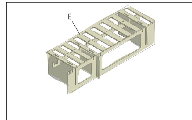
Lege die Finger-Abdeckplatte (E) so auf das vorgefertigte Unterteil auf, dass alle Zapfen in die vorgestanzten Nuten der Abdeckplatte passen. Drücke die Abdeckplatte fest.
