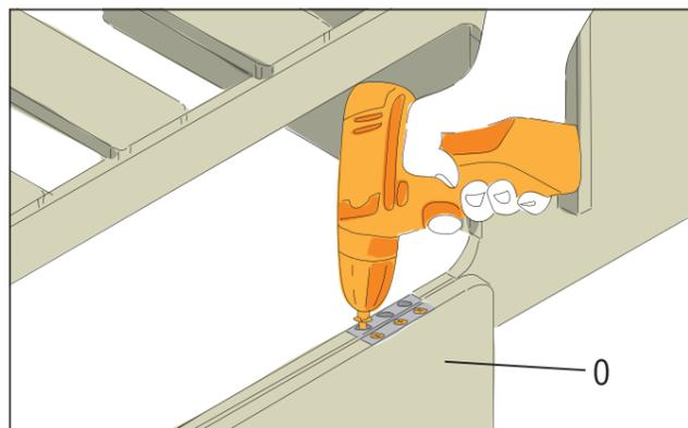
Befestige die Türen (0 + P) mit jeweils zwei Scharnieren an den Gehäuseöffnungen. Verschraube dazu die Scharniere mit Senkkopfschrauben 3 x 25 mm zuerst an den Schmalseiten der Türen und dann an den Gehäuseöffnung.
