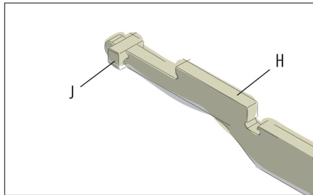
Der Stopper verhindert das Herausfallen des Ausziehelementes aus dem Gehäuse.
