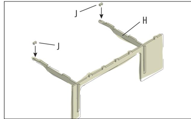
Entferne an den Stopper (J) die fertigungsbedingten kleinen Stege mit Schleifpapier. Setze den Stopper (J) in die Nut am Ende der Winkelstrebe ein – siehe auch nachfolgendes Detailbild. Montiere die zweite Winkelstrebe ebenso mit dem Stopper.
