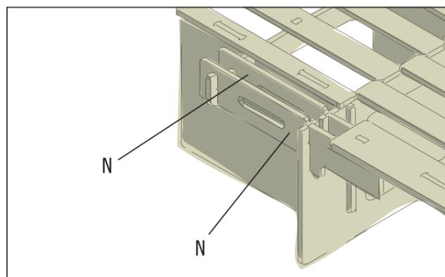
Setze die beiden Stützen (N) in die Nuten der überstehenden Strebe (D) und der Frontseite ein.
