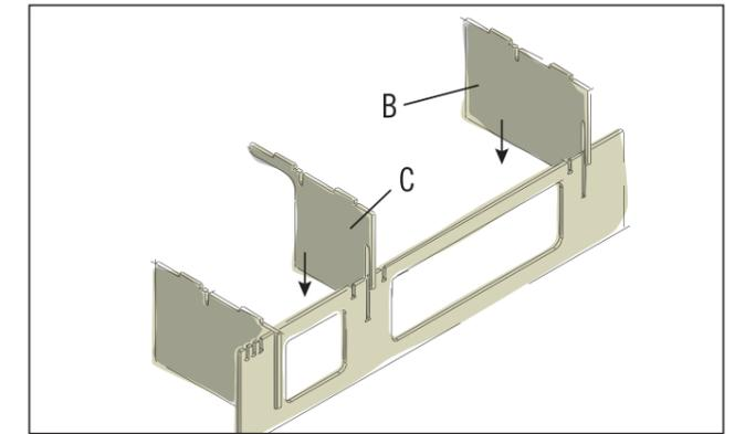
Stecke in die hintere Aussparung das zweite Wandelement (B) und in die mittlere Aussparung die Zwischenwand (C) ein. Die Bauteile müssen danach oben bündig abschliessen.
