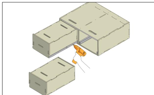
Die Montage der Schublade sollte auf einem ebenen und stabilen Untergrund erfolgen. Zum Ausrichten der Schublade kann man sehr gut Unterlegkeile verwenden. Sie sollte mit 17 mm unterbaut werden, damit sie beim Rein- und Rausschieben frei gleiten kann ohne zu schleifen.
