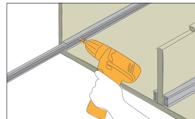
Verschraube die Schubladenschienen so, dass diese im eingeschobenen Zustand vorne bündig sind. Es werden die 4,5 x 16 mm Schrauben benötigt. Die Schraubenlöcher müssen nicht vorgebohrt werden.
