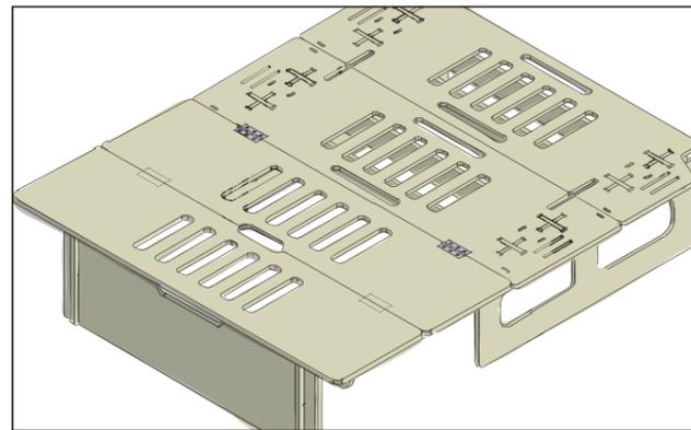
Die beiden Platten umdrehen und an den zuvor aufgesteckten Abdeckplatten mit zwei Scharnieren anschrauben. Ausgezogen bietet das Bett eine max. Liegefläche von L: 1800 mm x B: 1500 mm x H: 535 mm und zusammengeschoben eine Fläche von L: 1000 mm x B: 1500 mm x H: 535 mm.
