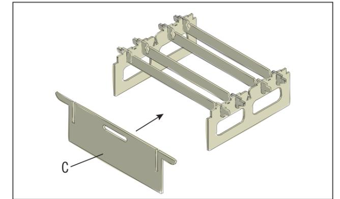
Die Frontplatte (C) vorne in die ausgesparten Ecken der Seitenwände einsetzen.
