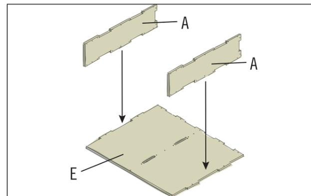
Die beiden Seitenwände (A) an den Aussparungen der Grundplatte (E) einsetzen. Das Bauteil aufstellen und die Seitenwände von unten durch die Grundplatte an den vorhandenen Bohrlöchern verschrauben. Zusätzlich werden die Seitenwände von aussen an der Grundplatte angeschraubt. Zur Verschraubung der Holzkonstruktion 3,5 x 35 mm Schrauben verwenden.
