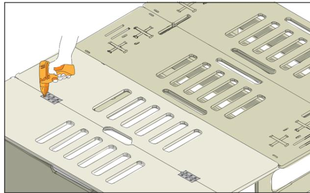
Richte die Platten so aus, dass die Grifföffnung zwischen beiden Platten ist. Verbinde sie mit zwei Scharnieren.
