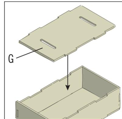
Die Abdeckung (G) wird nur lose aufgelegt. Sie kann zum Befüllen der Schublade leicht abgenommen werden.
