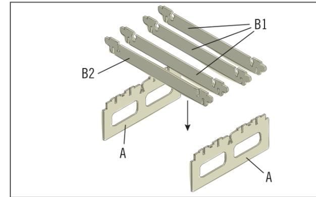
Stelle die beiden Seitenwände (A) mit einem Helfer auf. Die drei Streben (B1) und die Strebe (B2) dann von oben in die Aussparungen der Seitenwände einstecken.
