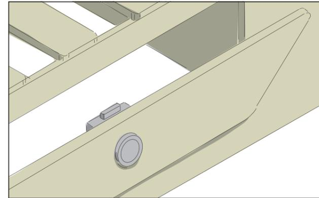
Jetzt wird das Push Lock Möbelschloss montiert. Dazu den bei der Campingbox mitgelieferten Anschlag von innen passend zum Push Lock Möbelschloss anbringen. Es werden 4 Senkkopfschrauben 3 x 16 mm benötigt.
