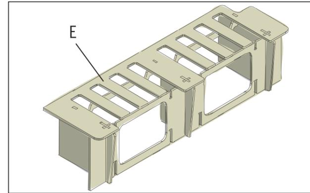
Setze die Finger-Abdeckplatte (E) auf das montierte Unterteil auf und stecke es an den nach oben stehenden Zapfen zusammen.
