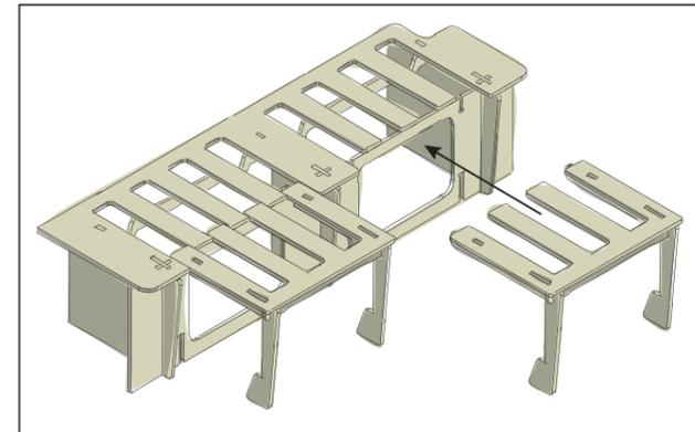
Verbinde die beiden Ausziehelemente mit dem Gehäuse. Die Finger der Abdeckplatten passen genau zusammen. Die Ausziehelemente kannst Du dann zum Stopper nach vorne ziehen.
