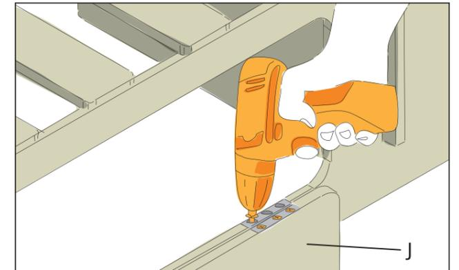
Befestige die Türen (J) mit jeweils zwei Scharnieren an den Gehäuseöffnungen. Verschraube dazu die Scharnieren mit Senkkopfschrauben 3 x 25 mm zuerst an den Schmalseiten der Türen und dann an den Gehäuseöffnung.
