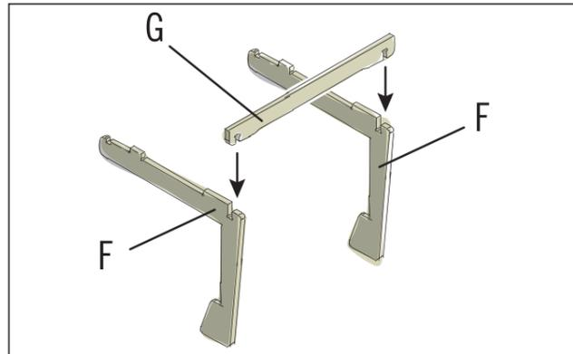
Das Ausziehelement wird zwei mal benötigt. Beide Elemente sind identisch. Verbinde die beiden Winkелеlemente (F) oben mit der Strebe (G).
