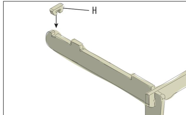
Stecke am Ende der Winkелеlemente jeweils einen Stopper (H) in die vorgesehene Aussparung. Er sorgt dafür, dass die Ausziehelemente nicht aus dem Gehäuse herausfallen.
