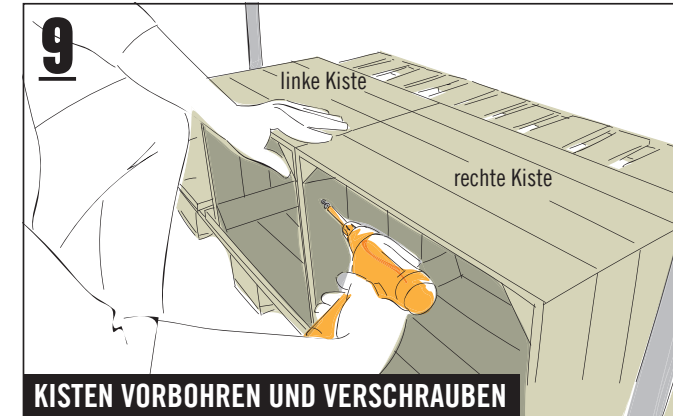
Im Inneren der Kisten acht Löcher mit dem „Bohrsenker“ vorbohren: vier Löcher, um die Kisten miteinander zu verbinden und jeweils vier Löcher, um die Kisten an der Palette zu befestigen. Anschließend mit Schrauben fixieren (siehe Bilder 9.1 und 9.2).
