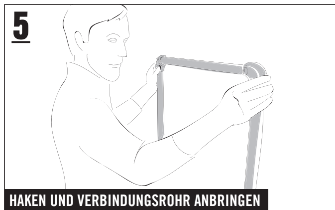
Die Haken auf die Stützrohre stülpen und das auf 960 mm gekürzte Verbindungsrohr mit jeweils einem Winkelstück an den Stützrohren (1430 mm) anbringen und mit einem Stiftschlüssel fixieren.
