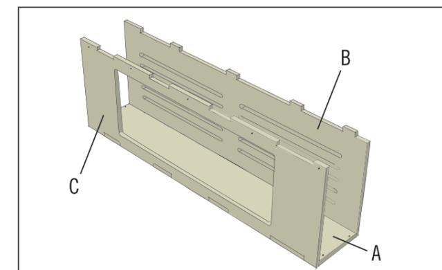
Das Seitenteil (C) wird parallel zum Seitenteil (B) auf die Bodenplatte (A) gesteckt und von unten durch die vorgebohrten Löcher mit 3x25 mm Holzschrauben verschraubt.
