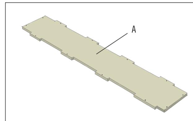
Lege die Bodenplatte (A) auf einen sauberen, ebenen Untergrund. Zum Schutz der Werkstücke und des Bodens kann ein grösserer Kartonbogen untergelegt werden.
