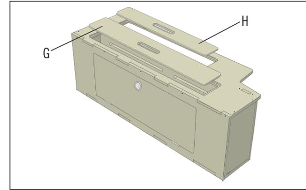
Zum Schluss werden noch die beiden Abdeckplatten (G) und (H) eingesetzt.
