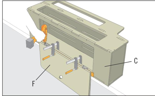
Stelle die Staubox an den Rand eines Arbeitstisches, und klemme die Frontklappe (F) mit Schraubzwingen fest, sodass die Schmalseiten der Klappe und der Klappenöffnung im Seitenteil (C) bündig nebeneinander sitzen. Die dazwischen geklemmte Holzleiste sorgt für den richtigen Abstand zwischen den Bauteilen. Achte darauf, dass die Ausfräsung für das Möbelschloss jetzt unten ist. Die Scharniere schraubst Du mit Holzschrauben Senkkopf 3x16 mm fest.
