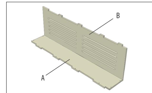
Das Seitenteil (B) wird auf die Bodenplatte (A) gesteckt. Die Verzapfungen der beiden Bauteile greifen genau ineinander.
