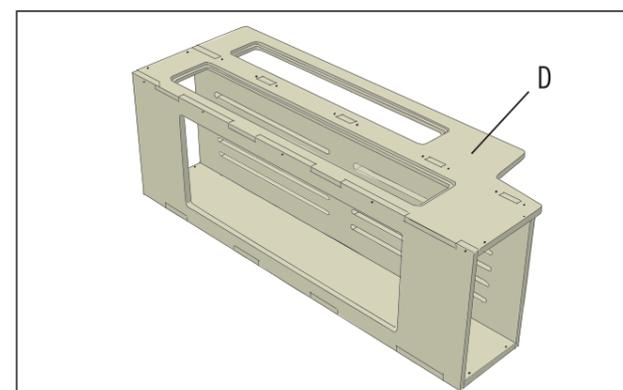
Die Deckplatte (D) wird von oben auf die Konstruktion gesteckt. In diesem Bauteil befinden sich ebenfalls mehrere Bohrlöcher, durch die es mit der Unterkonstruktion verschraubt wird. Verwende auch hier 3x25 mm Holzschrauben.
