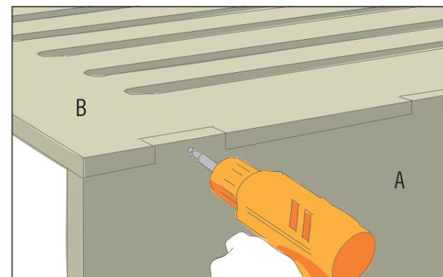
Kippe die Konstruktion für einen Moment auf die Seite, damit Du die Bodenplatte (A) mit dem Seitenteil (B) durch die vorgesehenen Bohrlöcher verschrauben kannst. Verwende hierfür 3x25 mm Holzschrauben.
