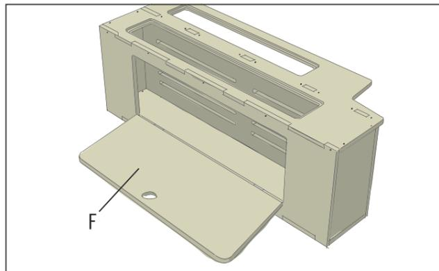
Die Frontklappe (F) ist nun montiert. Prüfe, ob sie sich öffnen und schliessen lässt, ohne zu haken.
