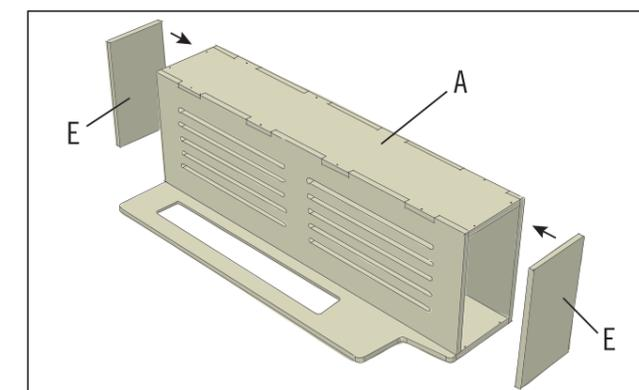
Nun wird das Objekt um 180° gedreht, sodass die Bodenplatte (A) nach oben zeigt. Füge die beiden Deckplatten (E) ein und verschraube diese analog zu den Seitenplatten von unten. Drehe die Stauraumbox dann wieder um und verschraube die Deckplatten (E) auch von oben mit 3x25 mm Holzschrauben.
