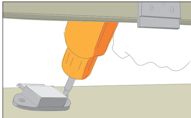
An der oberen Kante der Klappe befindet sich eine Ausfräsung für das Möbelschloss. Verschraube dieses mit Senkkopf Holzschrauben 3x16 mm.
