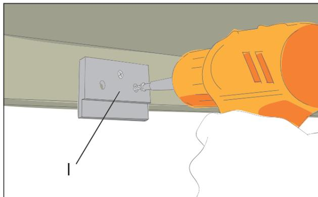
Der Anschlag (I) für das Möbelschloss der Frontklappe wird im Stauraum von innen in der Mitte der Klappenöffnung angeschraubt. Verwende hierfür Senkkopf Holzschrauben 3x16 mm.
