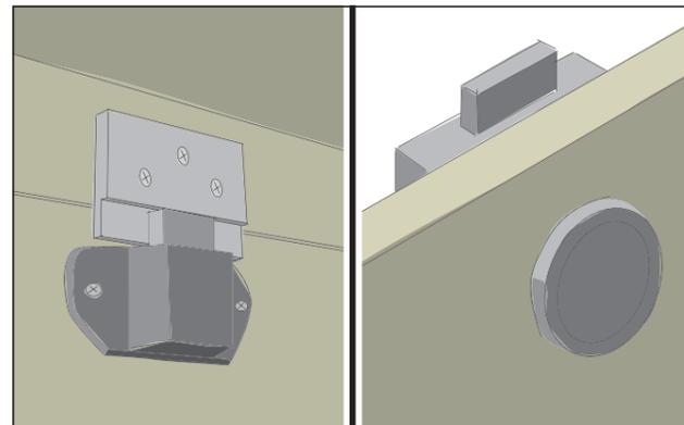
Wenn die Klappe geschlossen ist, greift der Riegel des Möbelschlusses hinter den Anschlag. Von aussen lässt sich das Möbelschloss per Knopfdruck bedienen.
