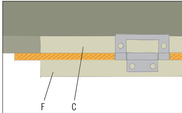
Die Frontklappe (F) wird durch zwei Lamellentürscharniere 50x23 mm mit dem Seitenteil (C) verbunden. Die Scharniere werden an die Schmalseiten von (F) und (C) geschraubt, wobei das Mass der Scharnier-Achse den Abstand zwischen (F) und (C) definiert. Eine Holzleiste mit diesem Mass kann als Abstandhalter eingeklemmt werden.
