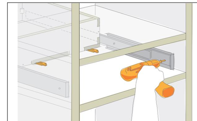
Setze die Schublade in die Schranköffnung ein und unterlege sie mit 2 mm dicken Keilen. Verschraube die Schubladenschiene am hinteren, dicken Teil an den Seitenwänden der Schranköffnung. Verwende Senkkopfschrauben 4x16 mm. Achte darauf, dass die Schienen parallel zur Schranköffnung montiert werden und sich die Schublade leichtgängig verschieben lässt.
