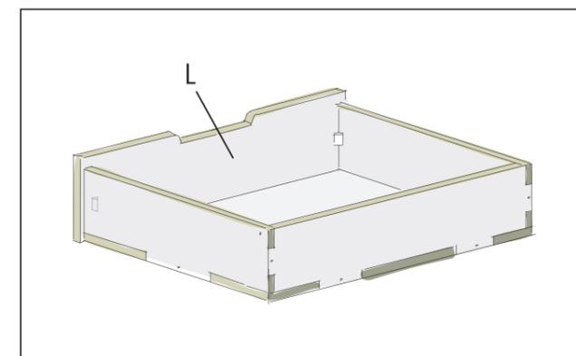
sen dazu nicht vorgebohrt werden. Danach kann die Frontplatte (L) an den Zapfen der Seitenwände und Grundplatte aufgesteckt und an den Eckverbinder angeschraubt werden.
