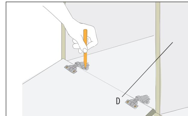
Bereite jetzt die Befestigungslöcher für die Türen am Schrankkorpus vor. Montiere dazu die Topfscharniere an den Türen (G), (H) und (M). Platziere die Türen jeweils an den Montagestellen und markiere die Schraubenpositionen durch die Montageplatten der Scharniere.
