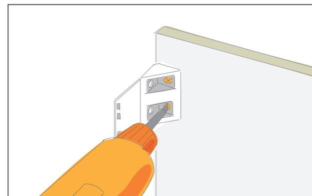
Damit die Frontplatte befestigt werden kann, muss auf jeder Seite ein Universal-Eckverbinder angeschraubt werden. Die Eckverbinder sitzen dabei vorne bündig an der Kante der Seitenwand. Schraube sie mit Senkkopfschrauben 3x16 mm an. Die Schraubenlöcher müs-
