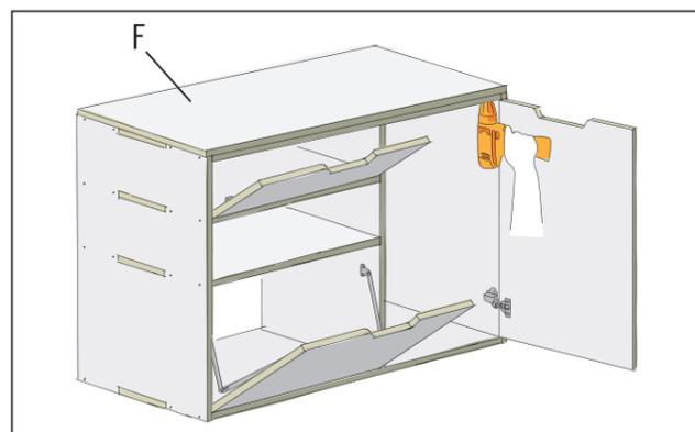
Senkkopfschrauben 3,5x35 mm. Lege die obere Schrankabdeckung (F) deckungsgleich auf die Abdeckplatte (A) auf. Sie wird von unten durch die Abdeckplatte mit Senkkopfschrauben 3x25 mm angeschraubt.
