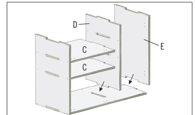
Stecke die beiden Schrankböden (C) in die Aussparungen der Seitenwand. Setze die Zwischenwand (D) und die Seitenwand (E) endgültig in die Aussparung der Bodenplatte ein. Die Verschraubung der Zwischenwand erfolgt zuerst mit Senkkopfschrauben 3,5x35 mm an den Schrankböden. Jetzt kann auch die Seitenwand (E) in den Zapfen an der Bodenplatte eingesteckt und wie zuvor verschraubt werden. Dann die Schrauben von unten durch die Bodenplatte in die Wände eindrehen.
