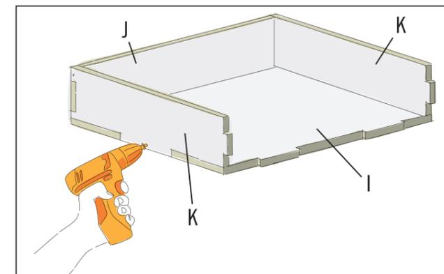
Verschraube die beiden Seitenwände (K) und die Rückwand (J) an der Grundplatte (I). Die Verschraubungen erfolgen von der Seite in die Grundplatte und dann durch die Grundplatte in die Wände. Es werden Senkkopfschrauben 3,5x35 mm verwendet.
