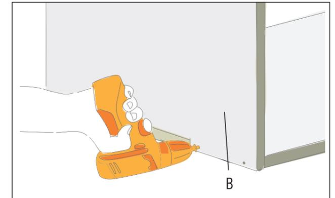
Verschraube die Seitenwand (B) mit Senkkopfschrauben 3,5x35 mm durch die vorgebohrten Schraubenlöcher. Nach dem Eindrehen der seitlichen Schrauben werden von unten zwei weiteren Senkkopfschrauben 3,5x35 mm durch die Zapfen in die Seitenwand eingedreht.
