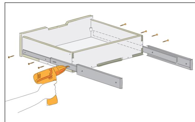
An der Schublade werden zwei Schubladenschiene angebracht. Ziehe die Schienen komplett auseinander und verschraube sie mit Senkkopfschrauben 4x16 mm durch den mittleren Teil des Auszuges direkt über der Bodenplatte der Schublade. Dann am vorderen Auszug ebenfalls an der Schublade verschrauben. Achte darauf, dass die Schienen parallel zur Schublade montiert werden.
