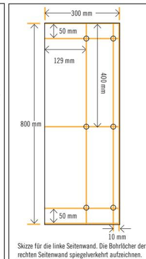
Skizze für die linke Seitenwand. Die Bohrlocher der rechten Seitenwand spiegelverkehrt aufzeichnen.
