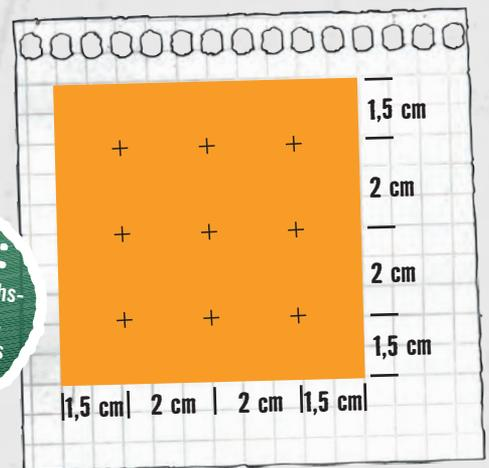
Spanne den Würfel in einen Schraubstock. Bohre mit dem Akkubohrer 9 Löcher mit dem 10 mm Holzbohrer senkrecht in den Holzblock.
