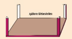
Klebe die Dreikantleisten an den vier Ecken des Bodenbrettes fest. Sie verleihen der Box Stabilität. Klebe nun von Seite A bis Seite D jede Seite mit dem Heisskleber an den Dreikantleisten und Seitenteilen des Bodenbrettes fest.
