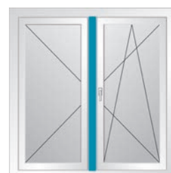
Portes de balcon à deux vantaux avec mécanisme oscillo-battant et montants mobiles
