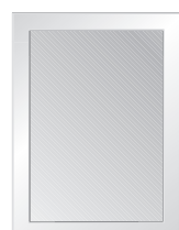
Fenêtre en une partie vitrée de façon fixe dans le châssis fixe
