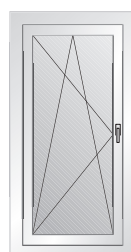
Porte de balcon à un vantail avec mécanisme oscillo-battant
