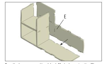
Remettre le corps en position debout. Monter la paroi arrière (E) par l'arrière. Les tenons et les fentes doivent s'insérer les uns dans les autres. Visser la paroi arrière au niveau des trous de vissage prévus à cet effet.
