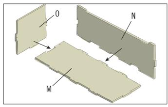
Assembler le panneau du bas (M) et les éléments de paroi (N et 0) aux fentes prévues à cet effet et visser. Le vissage s'effectue sur le côté et par le bas à travers le panneau du bas.
