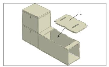
Le cache (L) peut être posé à l'essai. Il reste ensuite sans fixation pour pouvoir être retiré afin de remplir le tiroir.
