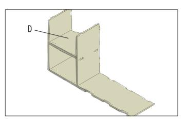
Écarter légèrement les deux éléments de paroi et emboîter le panneau intermédiaire (D) dans les fentes.
