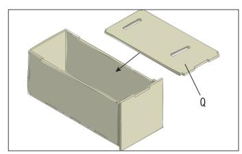
Le cache (Q) est simplement posé sans fixation, c'est à dire, sans être vissé. Il peut être retiré facilement au niveau des fentes des poignées afin de remplir le tiroir. Il ne reste plus qu'à monter les coulisses pour tiroir.
