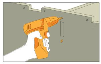
Visser toutes les pièces au niveau des trous de perçage en place à l'aide de vis de 3 x 35 mm.
