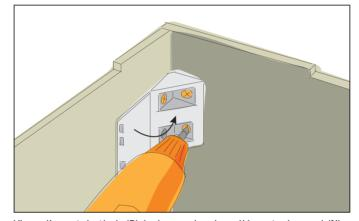
Visser l'avant du tiroir (P) à chacun des deux éléments de paroi (N) par l'intérieur à l'aide de deux raccords d'angle.
