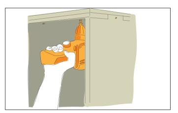
Visser le plan de travail par le bas à travers les trous de percage du panneau de recouvrement prévus à cet effet à l'aide de vis de 3 x 25 mm.
