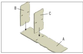
Effectuer de préférence les travaux de montage suivants à deux. Poser le panneau du bas (A) sur un support droit, comme indiqué. Emboîter les deux éléments de paroi dans les fentes du panneau. L'élément B se place à gauche. Les fentes se trouvent à l'arrière. L'élément C se place à droite. Les tenons se trouvent à l'arrière.
