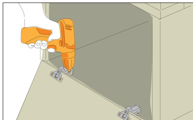
Chacune des deux portes se fixe au moyen de deux charnières invisibles aux ouvertures prévues à cet effet. Les charnières sont vissées à l'aide de vis de 3 x 16 mm.
