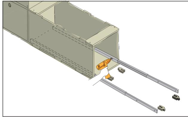
Les deux coulisses pour tiroir sont vissées aux parois en bas à l'intérieur du corps. Le montage du tiroir doit être effectué sur un support plan et stable. L'utilisation de cales pour orienter le tiroir peut être très utile. Il doit mesurer 17 mm de moins afin de glisser sans frotter, à l'ouverture comme à la fermeture.
