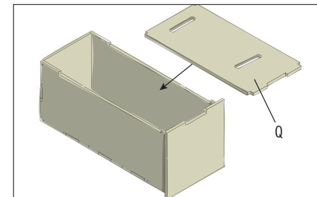
Le cache (Q) est simplement posé sans fixation, c'est à dire, sans être vissé. Il peut être retiré facilement au niveau des fentes des poignées afin de remplir le tiroir. Il ne reste plus qu'à monter les coulisses pour tiroir.
