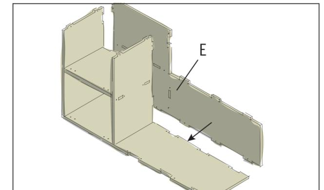
Remettre le corps en position debout. Monter la paroi arrière (E) par l'arrière. Les tenons et les fentes doivent s'insérer les uns dans les autres. Visser la paroi arrière au niveau des trous de vissage prévus à cet effet.
