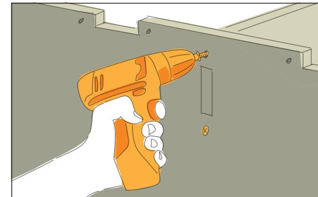
Visser toutes les pièces au niveau des trous de perçage en place à l'aide de vis de 3 x 35 mm. Basculer le corps sur le côté et visser les deux éléments de paroi à travers le panneau du bas. Visser le panneau intermédiaire à travers les deux éléments de paroi.
