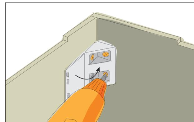
Visser l'avant du tiroir (P) à chacun des deux éléments de paroi (N) par l'intérieur à l'aide de deux raccords d'angle.
