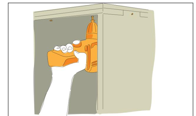
Visser le plan de travail par le bas à travers les trous de perçage du panneau de recouvrement prévus à cet effet à l'aide de vis de 3 x 25 mm.
