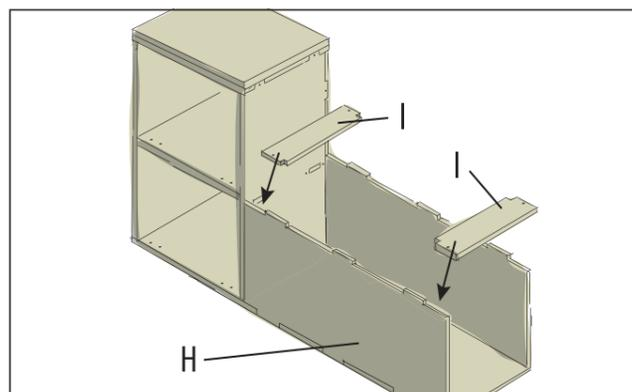
Emboîter le panneau avant (H) avec le panneau du bas. Poser les deux planches de raccordement (I) à gauche et à droite sur le corps et visser par le haut sur la face arrière et le panneau avant. Basculer l'ensemble du corps sur la gauche afin de visser le panneau avant sur le fond.
