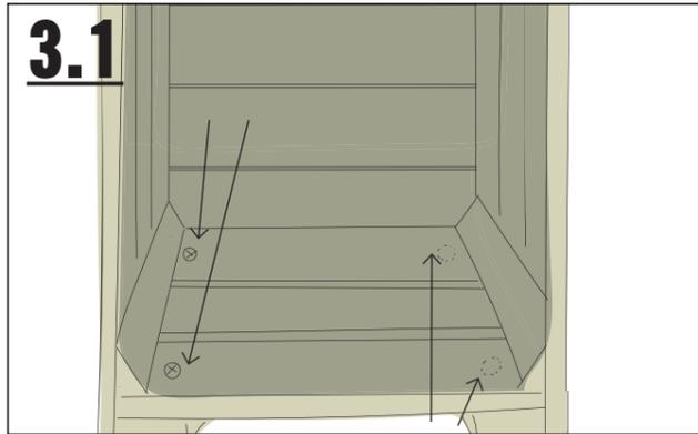
3.1 ... avec à chaque fois deux vis sur le dessus et deux vis par en dessous.
