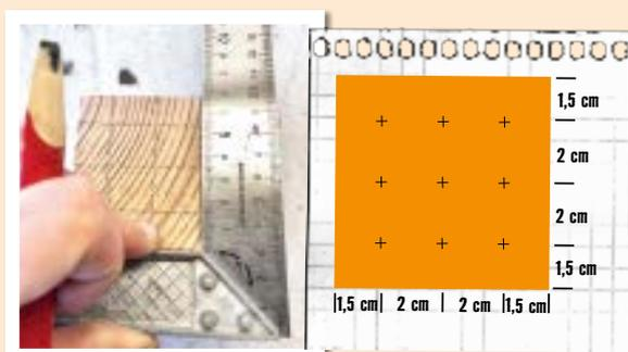
**02** Place le cube dans un étau. Avec la perceuse sans fil, perce 9 trous à l'aide du foret à bois de 10 mm verticalement dans le bloc en bois.
