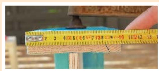
**04** Perce maintenant deux trous au centre de la latte et visse la latte à ton morceau de bois. Tu dois travailler avec précision pour que les vis touchent aussi le centre du morceau de bois fin.
