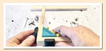
**03** Pour commencer, raccorde deux angles de la même façon, c'est-à-dire en mettant bout à bout une latte longue et une latte courte. Fixe chaque angle avec 2 clous. Place en plus l'angle dans un étau. Place les deux angles l'un contre l'autre de sorte à obtenir un rectangle uniforme. Relie aussi les deux derniers angles avec 2 taquets à clouer.
