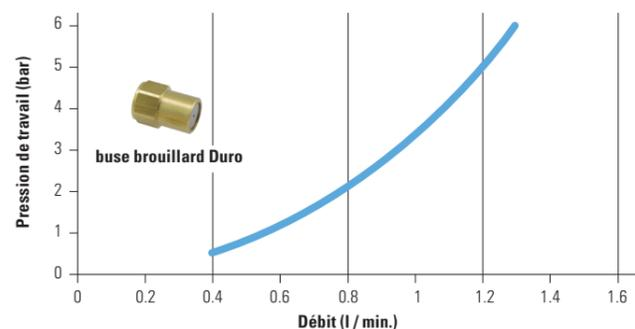
**Puissance de pulvérisation buse réglable 1.3 mm**
