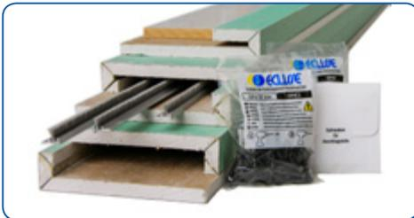
Die Planbox aus Gipskarton-Formteilen bietet eine einfache Möglichkeit um UNICO für Trockenbau optisch wandbündig zu verkleiden. Lieferbar für 1- und 2-flg. ECLISSE UNICO-Modelle, für die fertigen Wandstärken 12,5 | 15 | 17,5 cm. Die passgenauen Formteile sind in Feuchtraumqualität GKBI 12,5 mm ausgeführt, inkl. Staubbürsten in Alu-Profilen, GK-Schrauben für zweite Belegung (3,9 x 32) und weißer Anschlagplatte aus Holzwerkstoff geeignet zur Montage von Schließblechen.
