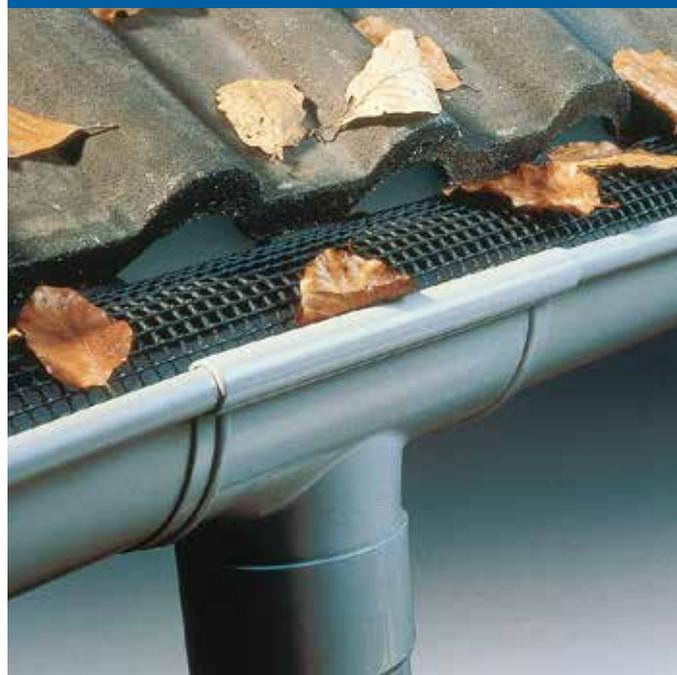
**Déposez simplement la grille de retenue Poly-Net Laubstop** dans la gouttière et les feuilles n'ont plus aucune chance. Celles-ci restent sur la surface bombée, se dessèchent et sont ensuite emportées par le vent. Poly-Net Laubstop en polyéthylène (PE) est incassable, anticorrosif, résistant aux fortes températures et recyclable à 100 %. Convient aux gouttières DI 150-180, DI 100-125 et gouttières carrées (jusque DI 100).
