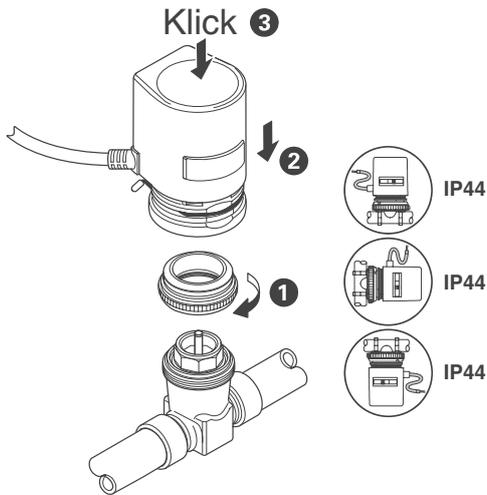
**Abb. 1 Montage / Einbaulagen**
