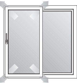
Porte-fenêtre coulissante parallèle (sans fonction battante)
