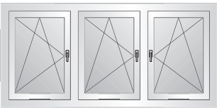
Fenêtre à trois vantaux avec mécanisme oscillo-battant
