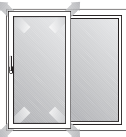
Porte-fenêtre coulissante parallèle (sans fonction battante)
