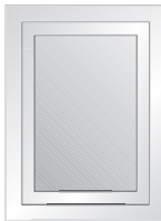
Fenêtre à un vantail à vitrage fixe dans le dormant/ fenêtre à vantail vissé
